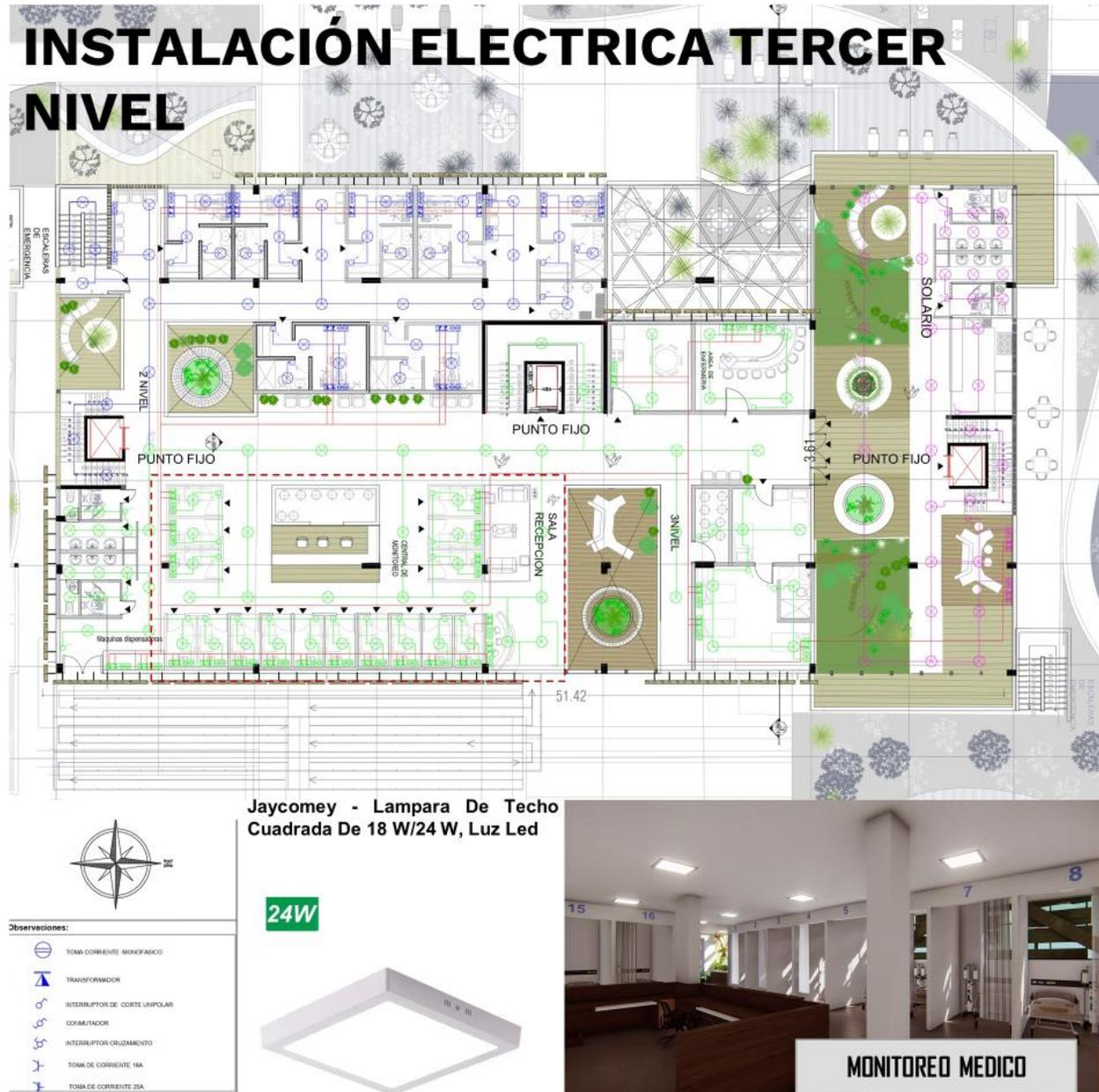
**Nota.** La figura muestra que en el sistema eléctrico se implementaran lámparas de techo cuadrada de 18 w/24 w, luz led que ahorran más del 90 % en comparación con las lámparas tradicionales.,
