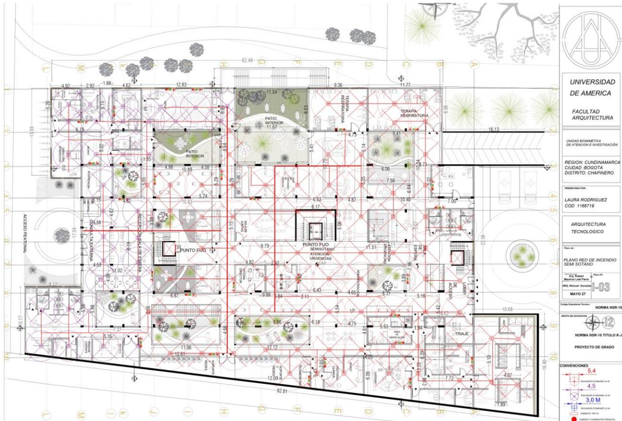
**Nota.** La figura muestra que se tiene en el semisótano dos tipos de rociadores entre ellos de 4.5 y 5.4 y gabinetes tipo 3.
