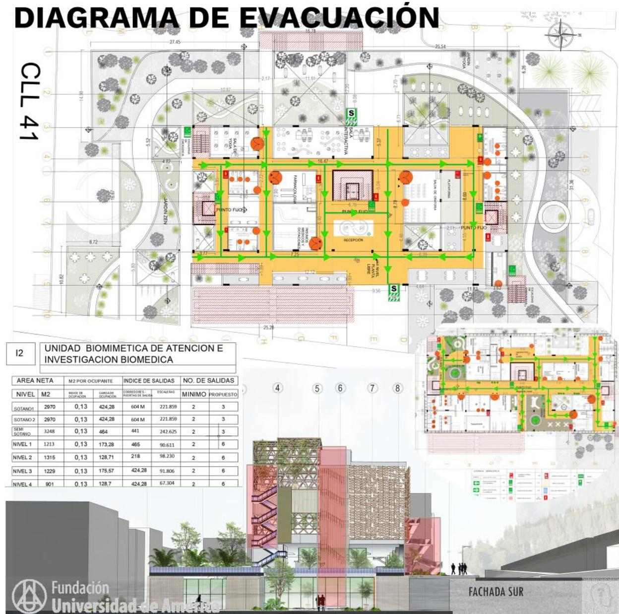
**Nota.** La figura muestra que se tienen 3 salidas dos escaleras de emergencia los extremos del edificio y una rampa que se encuentra por la carrera 7.
