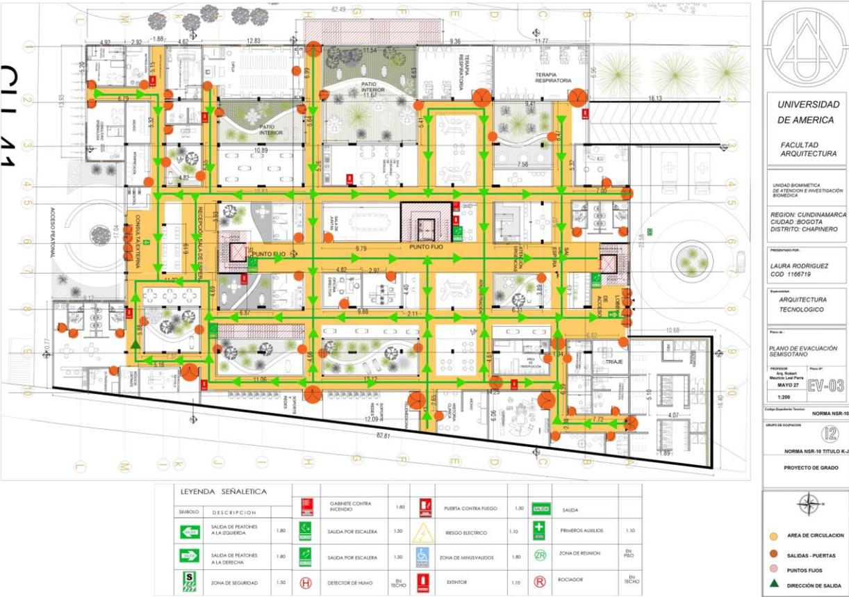
**Nota.** La figura muestra que en el semisótano se tiene 4 salidas de emergencia.
