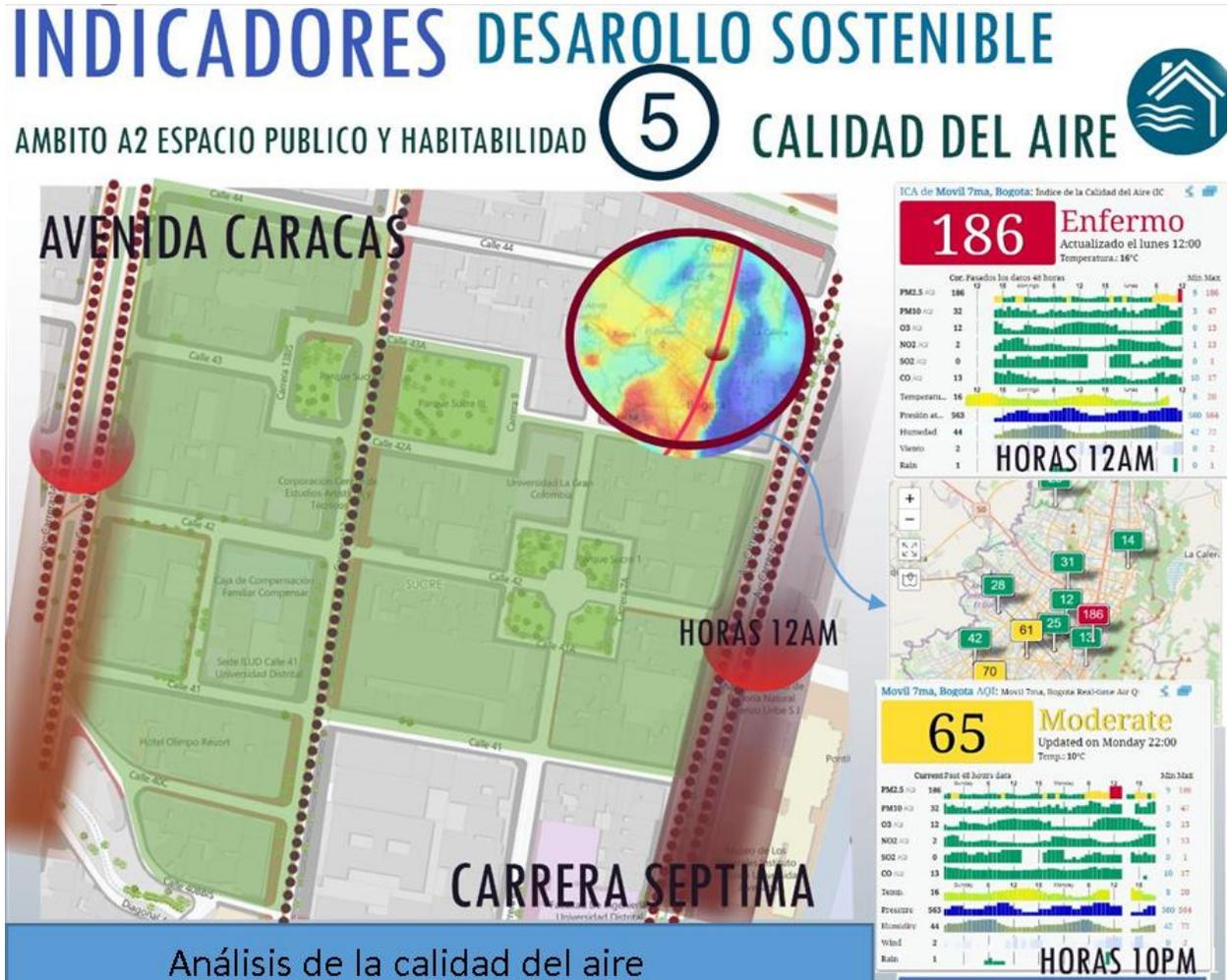
**Nota.** La figura muestra el monitoreo de la calidad del aire en la carrera séptima y se concluye que a las horas del mediodía el nivel en la carrera séptima se clasifica como enfermo y a las diez pm bajo a moderado lo que indica que durante el día y la actividad determina un riesgo continuo para la ciudad y los habitantes que circulan la zona. Tomado de: [ indicaciones del monitoreo de calidad de aire sector carrera séptima Bogotá]. (agosto 25 2020). Observatorio Ambiental de Bogotá
