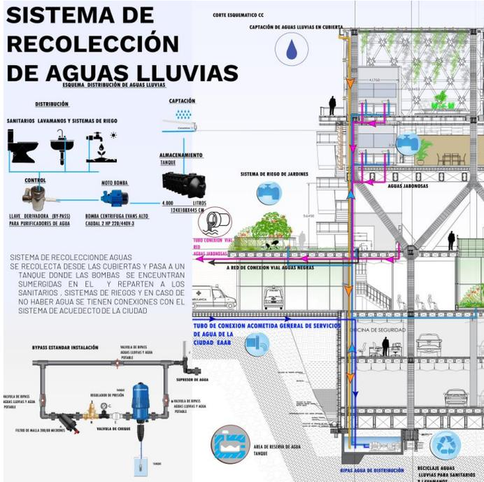
**Nota.** La figura muestra que se adecuaron dispositivos para controlar la información de las partículas de CO<sub>2</sub> para analizar datos en laboratorio y el uso de la estrategia de reutilización de aguas lluvias permite ahorrar agua y usarse en los baños y zonas de servicio como cafeterías y espacio público.
