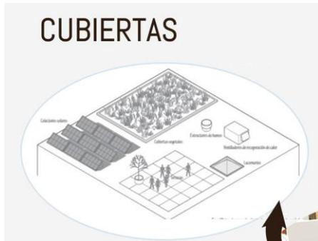
**Nota.** La figura muestra el uso de las cubiertas verdes y el uso de paneles fotovoltaicos como estrategias para la eficiencia energética del edificio para mitigar el impacto ambiental del sector.
