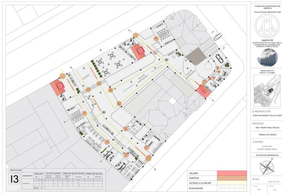
Nota. Salidas de emergencia planta primer nivel
