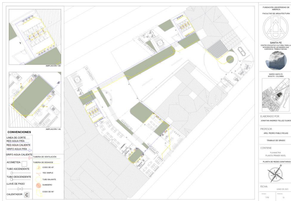
Figura 29. Planta primer nivel de redes sanitarias
