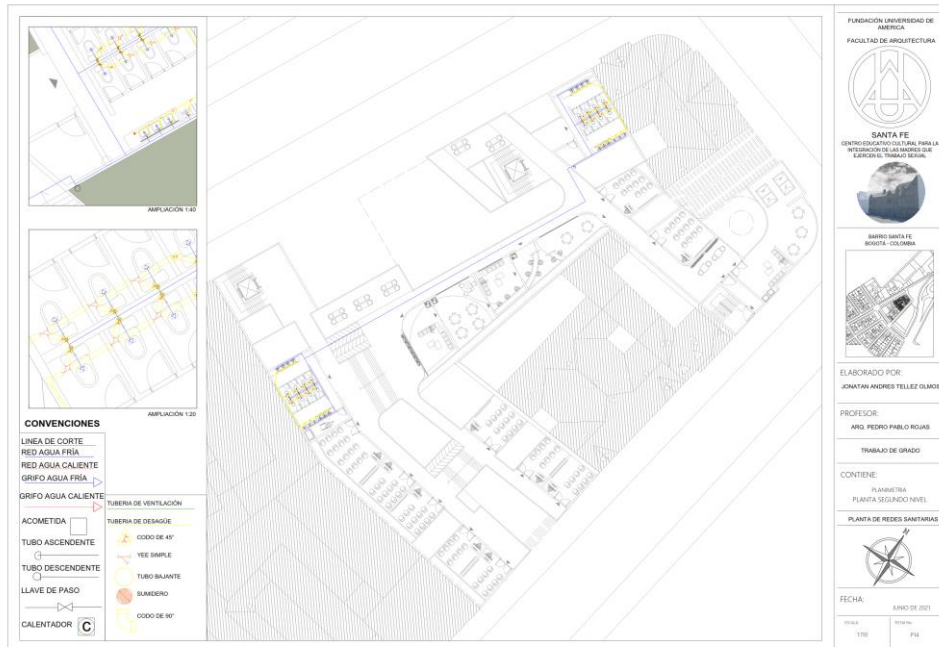
Figura 30. Planta segundo nivel de redes sanitarias
