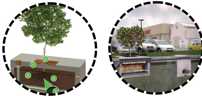
**Nota.** Sistemas de recolección aguas lluvias por medio de filtros bajos los árboles. Tomado de: Contech Engineered Solutions. (s.f). “Filterra bioretention”. [En línea]. <https://www.conteches.com/stormwater-management/biofiltration-bioretention/filterra>
