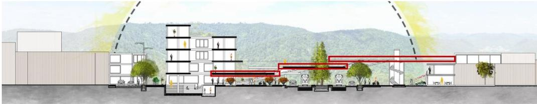
**Nota.** Se evidencia en el corte los distintos niveles en los que se divide la plataforma y como conecta a cada costado del área aferente del Regiotram sobre la Cra 17.
