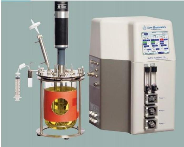
**Nota.** La figura representa el biorreactor empleado en este proyecto identificado como Bio- Flo/CelliGen 115. Tomado de: D. Totaro *et al.* Microscale perfusion-based cultivation for pichia pastoris clone screening enables accelerated and optimized recombinant protein production processes. *Biotechnology Journal*, n/a:2000215, 2020. doi: 10.1002/biot.202000215; 02.
