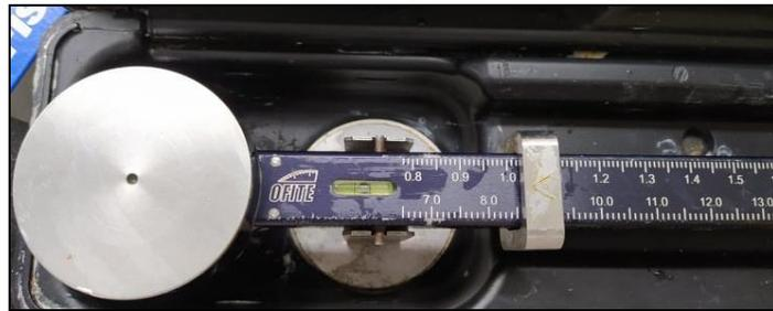
*Nota: En la imagen se muestra el resultado obtenido en la prueba de densidad para el lodo con agua resultante del polímero Lipesa 1641.*
