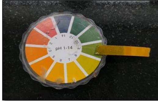
*Nota. En la imagen se muestra el resultado obtenido con la cinta de pH para el lodo de inicio con agua resultante del proceso de dewatering utilizando el polímero Kemira 1143.*
