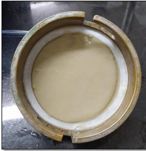
*Nota. En la imagen se presenta el resultado final de la prueba de filtrado del lodo con agua resultante del polímero Lipesa 1641, donde finalmente se midió el revoque.*
