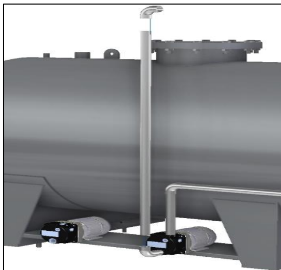
Figura 108. Segmento cuarto de línea de retorno
