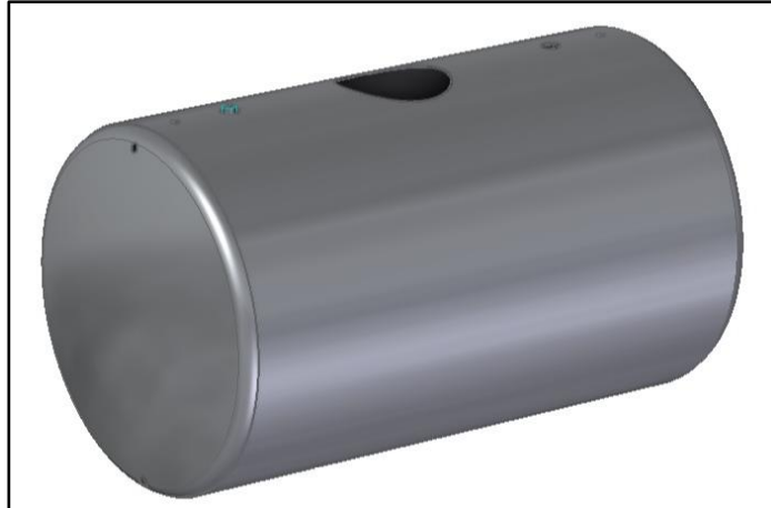
Figura 94. Posición final de las tapas para soldadura
