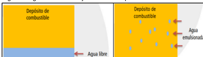
Figura 4. Agua emulsionada y libre en los depósitos de combustibles
