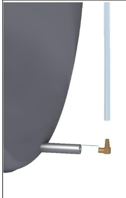
Figura 123. Instalación de visor de nivel
