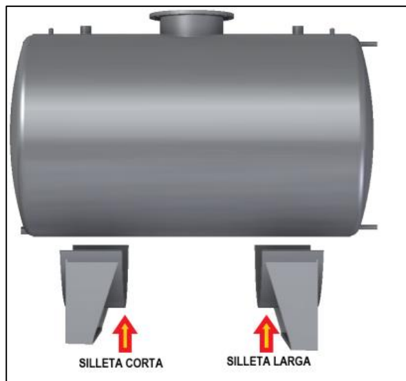
Figura 99. Ensamblaje de las silletas en el tanque
