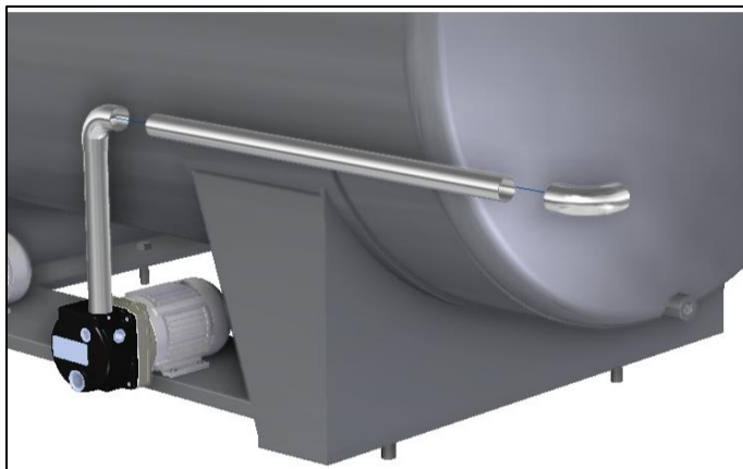
Figura 104. Instalación línea de retorno segundo segmento
