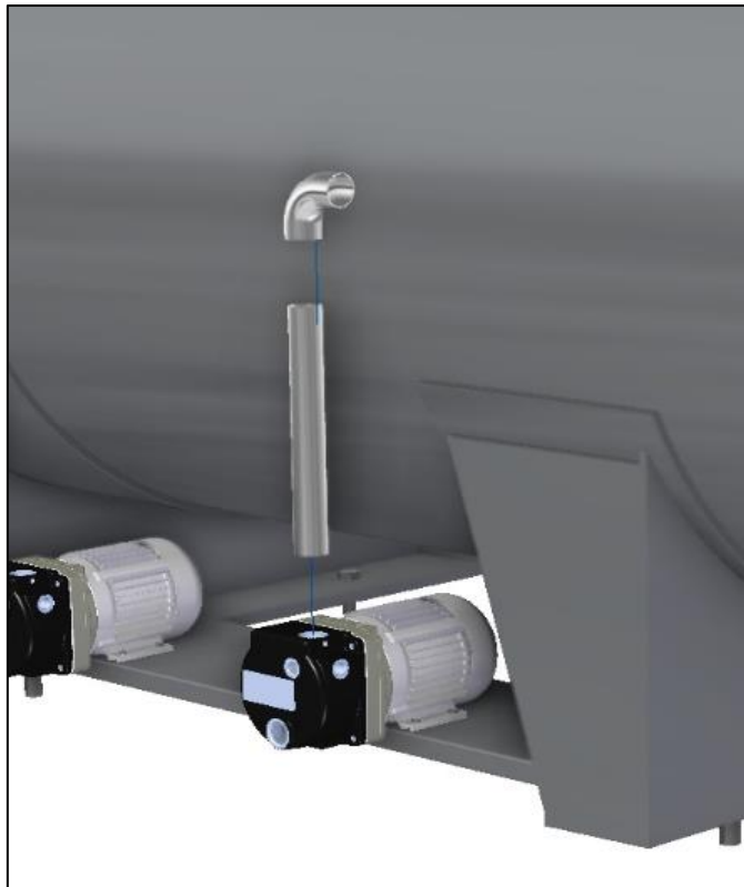
Figura 103. Instalación línea de retorno primer segmento
