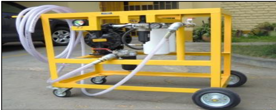
Figura 5. Equipo para limpiar el tanque de consumo de combustible por recirculación
