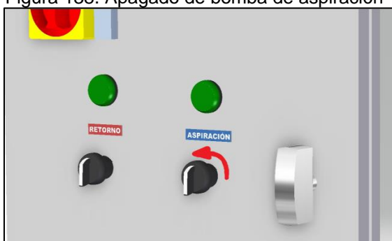
Figura 138. Apagado de bomba de aspiración
