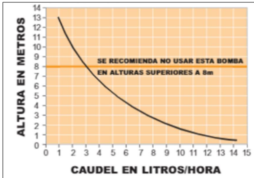
Gráfica 17. Curva de funcionamiento Altura vs Caudal mini Orange
