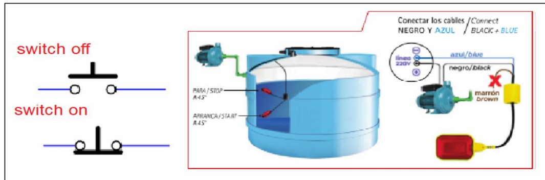
Ilustración 72. Control de nivel tanque superior
