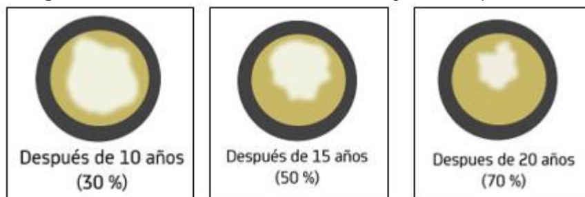
Imagen 6. Efecto corrosivo en tuberías a lo largo del tiempo
