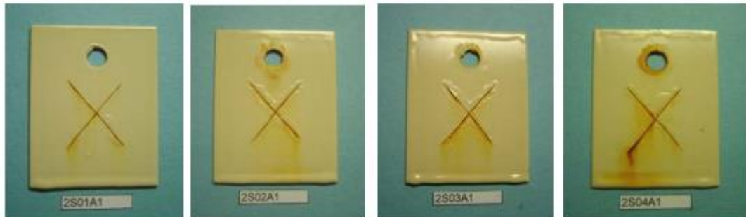
Imagen 10. Resultados del ensayo aspa en probetas de acero cubiertas con pintura epoxi.
