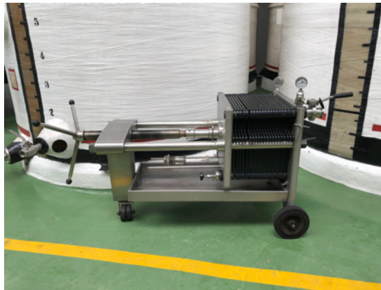
Figura 4. Filtro de placas
