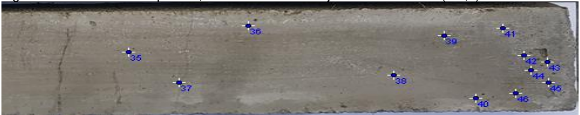
Figura 50. Sección 2 de la pieza 3, distribución de burbujas de diámetro D1 (0-1,0) mm
