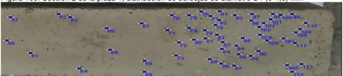
Figura 100. Sección 2 de la pieza 1, distribución de burbujas de diámetro D1 (0-1,0) mm
