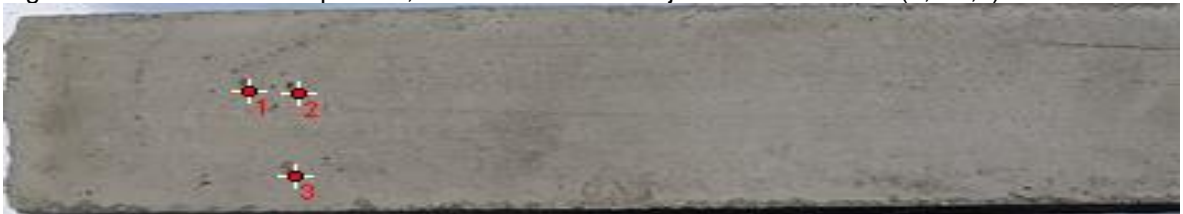
Figura 87. Sección 1 de la pieza 2, distribución de burbujas de diámetro D2 (1,1-2,0) mm
