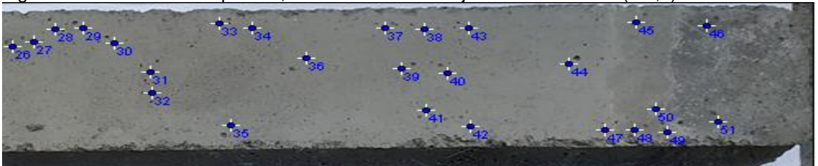
Figura 70. Sección 2 de la pieza 1, distribución de burbujas de diámetro D1 (0-1,0) mm
