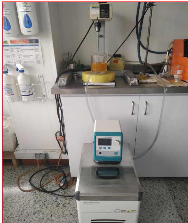
Figura 113. Montaje del sistema para la elaboración de emulsiones
