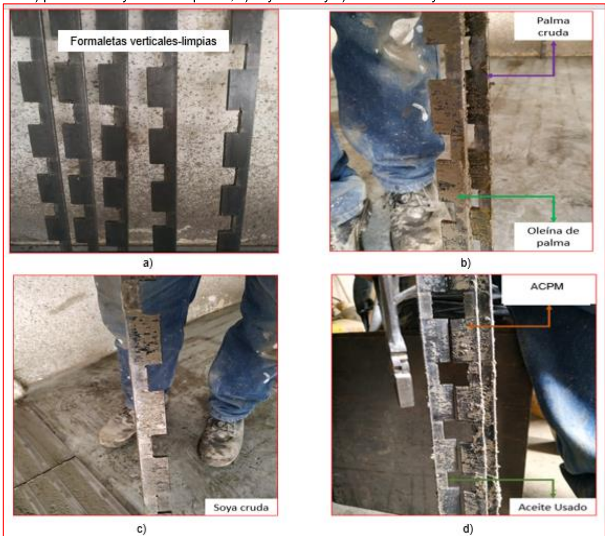
Figura 18. Formaletas metálicas verticales a) limpias, con fracción de pega en el área de contacto con b) palma cruda y oleína de palma, c) soya cruda y d) aceite usado y ACPM.
