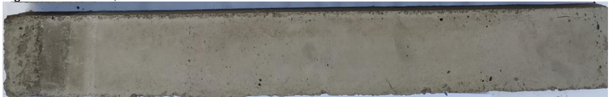
Figura 91. Pieza 3, área de contacto con aceite usado
