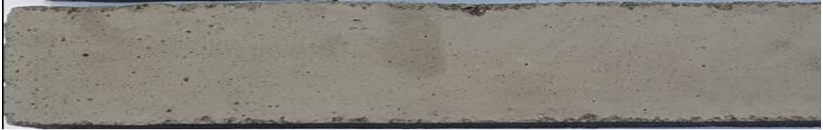
Figura 72. Sección 1 de la pieza 2, distribución de burbujas de diámetro D2 (1,1-2,0) mm
