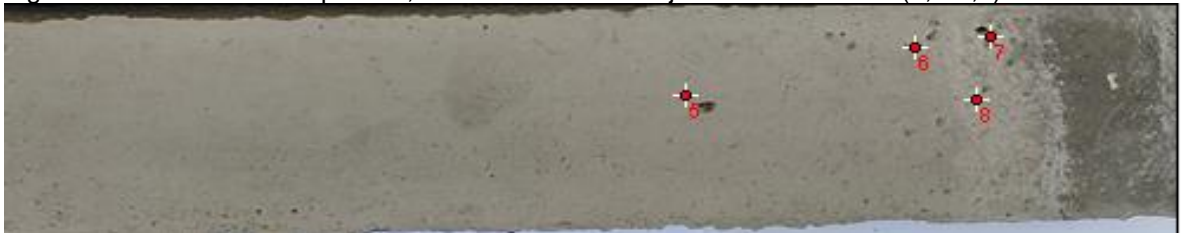
Figura 63. Sección 2 de la pieza 3, distribución de burbujas de diámetro D2 (1,1-2,0) mm
