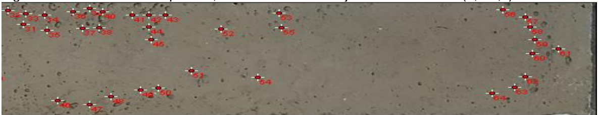
Figura 108. Sección 2 de la pieza 3, distribución de burbujas de diámetro D2 (1,1-2,0) mm
