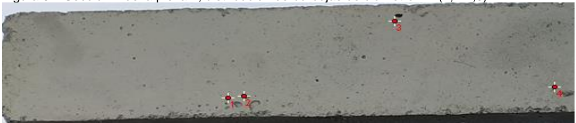
Figura 67. Sección 1 de la pieza 1, distribución de burbujas de diámetro D2 (1,1-2,0) mm
