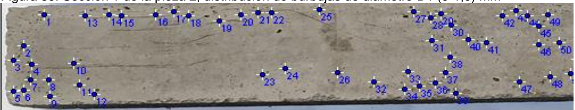
Figura 59. Sección 1 de la pieza 2, distribución de burbujas de diámetro D1 (0-1,0) mm
