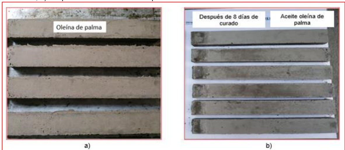
Figura 29. Área de contacto de las piezas de concreto con oleína de palma: a) antes del proceso de curado, b) después de 8 días de curado por método de inmersión.
