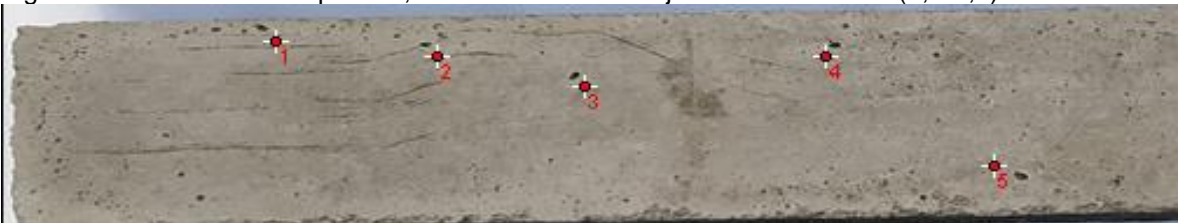
Figura 57. Sección 1 de la pieza 2, distribución de burbujas de diámetro D2 (1,1-2,0) mm
