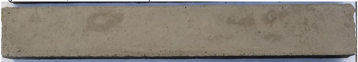
Figura 41. Pieza 2, área de contacto con palma cruda
