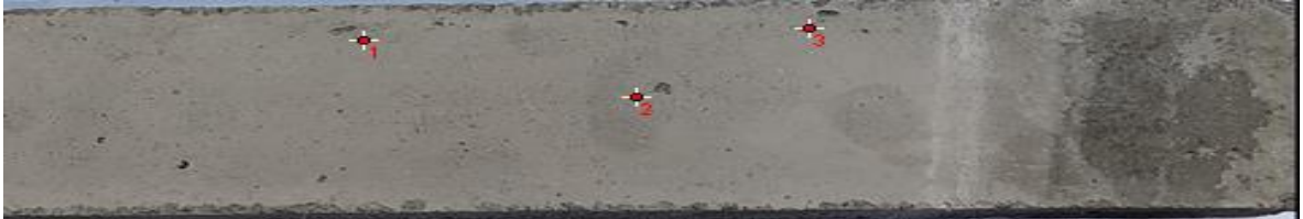
Figura 73. Sección 2 de la pieza 2, distribución de burbujas de diámetro D2 (1,1-2,0) mm
