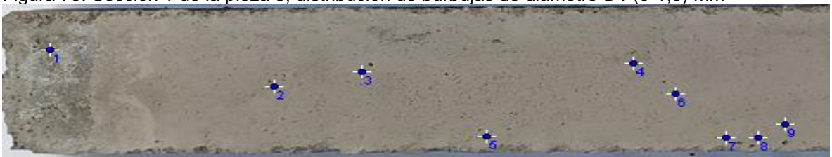
Figura 79. Sección 1 de la pieza 3, distribución de burbujas de diámetro D1 (0-1,0) mm
