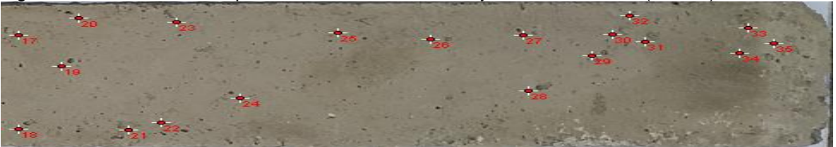
Figura 103. Sección 2 de la pieza 2, distribución de burbujas de diámetro D2 (1,1-2,0) mm
