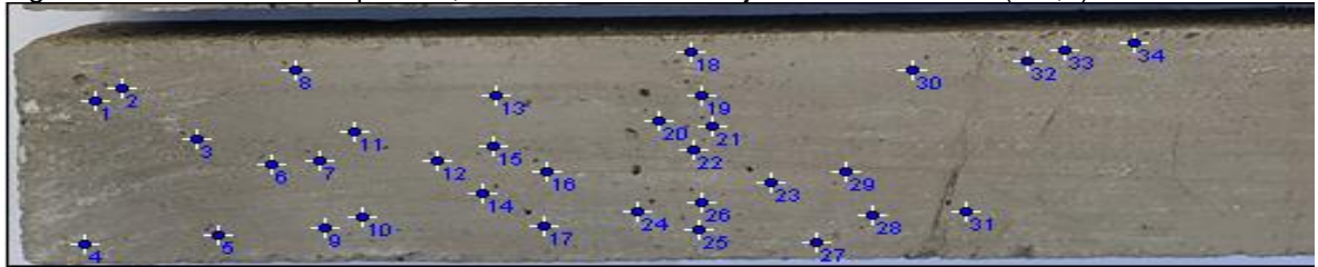
Figura 49. Sección 1 de la pieza 3, distribución de burbujas de diámetro D1 (0-1,0) mm
