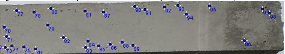
Figura 55. Sección 2 de la pieza 1, distribución de burbujas de diámetro D1 (0-1,0) mm
