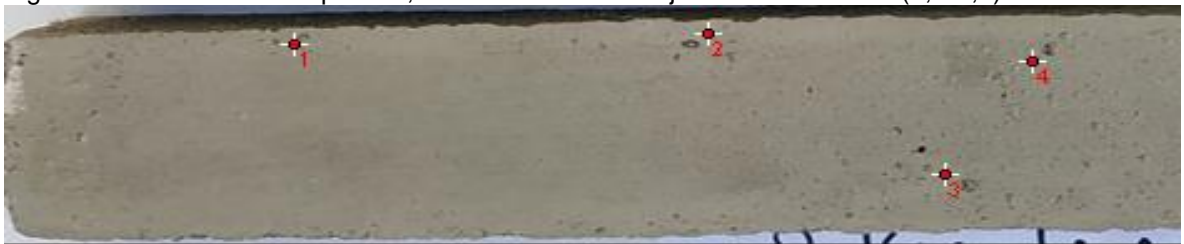
Figura 62. Sección 1 de la pieza 3, distribución de burbujas de diámetro D2 (1,1-2,0) mm
