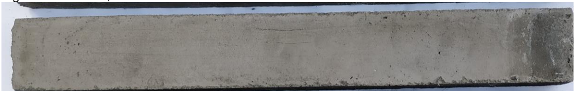
Figura 86. Pieza 2, área de contacto con aceite usado
