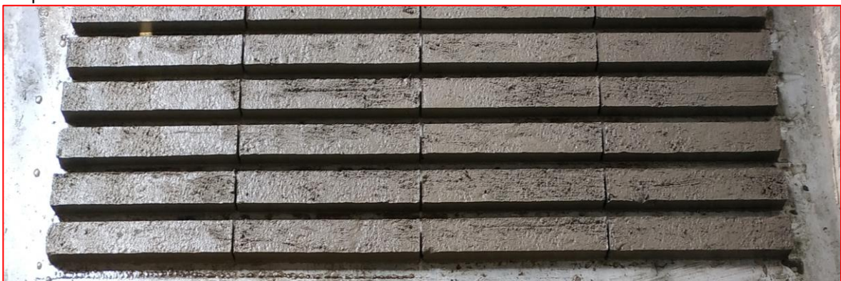
Figura 22. Área de contacto de las piezas de concreto con los aceites vegetales y sus derivados, después de remover las formaletas laterales al transcurrir 24 horas.
