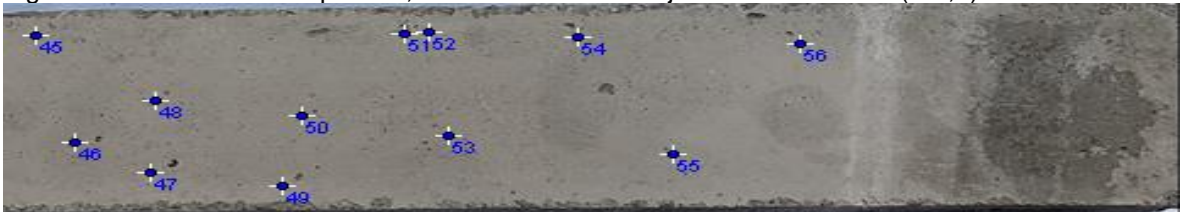
Figura 75. Sección 2 de la pieza 2, distribución de burbujas de diámetro D1 (0-1,0) mm
