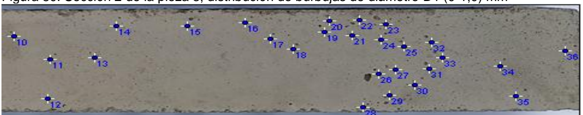
Figura 80. Sección 2 de la pieza 3, distribución de burbujas de diámetro D1 (0-1,0) mm
