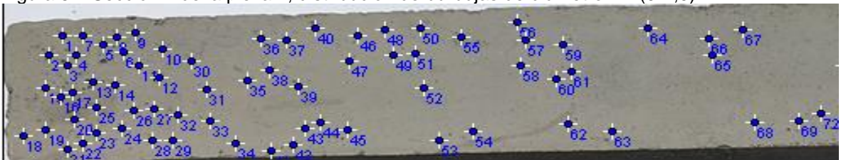
Figura 54. Sección 1 de la pieza 1, distribución de burbujas de diámetro D1 (0-1,0) mm
