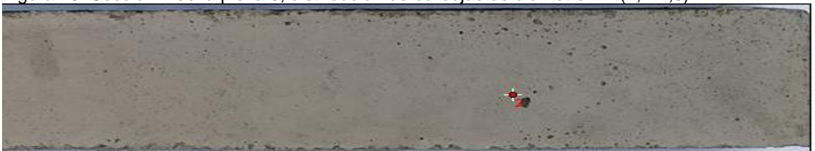
Figura 78. Sección 2 de la pieza 3, distribución de burbujas de diámetro D2 (1,1-2,0) mm
