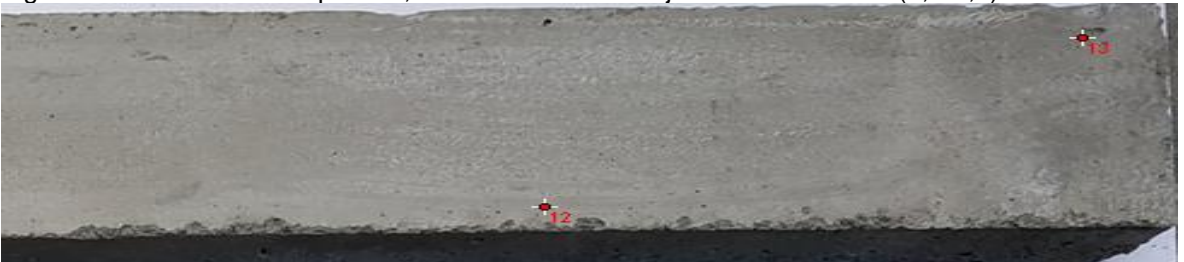
Figura 38. Sección 2 de la pieza 1, distribución de burbujas de diámetro D2 (1,1-2,0) mm
