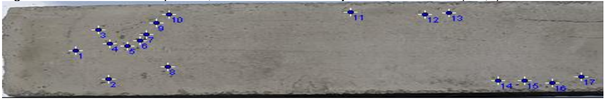
Figura 89. Sección 1 de la pieza 2, distribución de burbujas de diámetro D1 (0-1,0) mm
