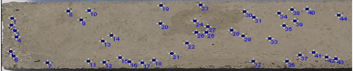
Figura 44. Sección 1 de la pieza 2, distribución de burbujas de diámetro D1 (0-1,0) mm
