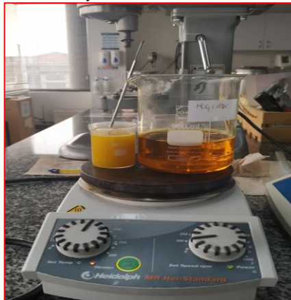
Figura 115. Mezcla entre la muestra de aceite y emulsificante
