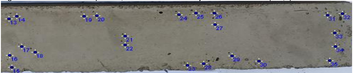
Figura 95. Sección 1 de la pieza 3, distribución de burbujas de diámetro D1 (0-1,0) mm
