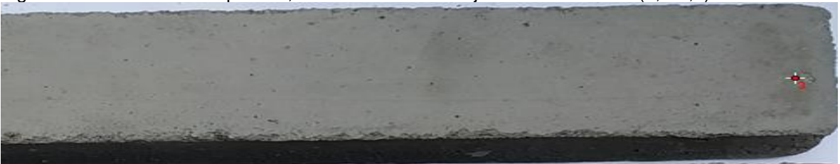
Figura 83. Sección 2 de la pieza 1, distribución de burbujas de diámetro D2 (1,1-2,0) mm
