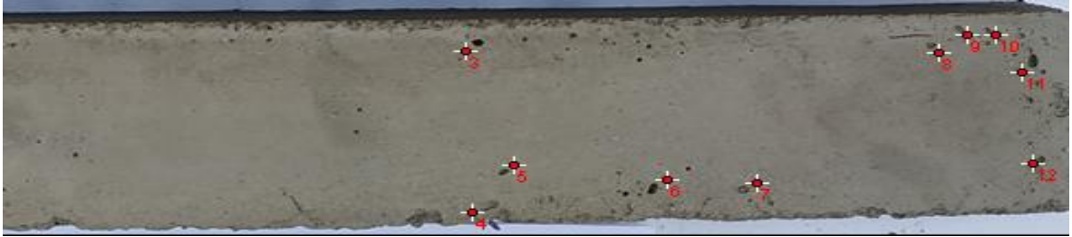
Figura 93. Sección 2 de la pieza 3, distribución de burbujas de diámetro D2 (1,1-2,0) mm
