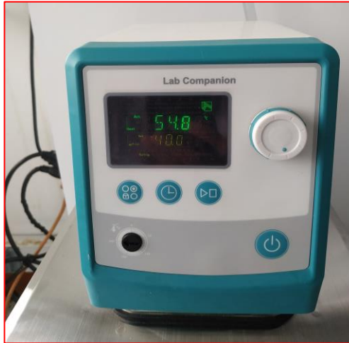
Figura 120. Ajuste de la temperatura a un valor deseado o setpoint de 40°C
