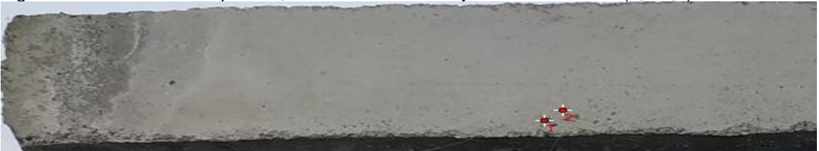
Figura 82. Sección 1 de la pieza 1, distribución de burbujas de diámetro D2 (1,1-2,0) mm
