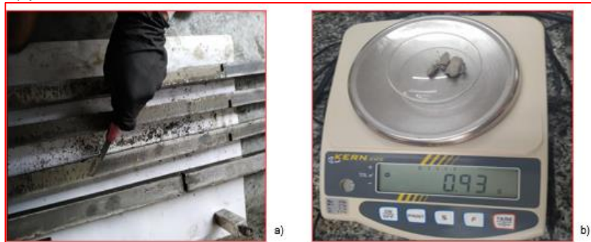
Figura 144. Fracción de pega del concreto, a) adherida a la formaleta, b) pesada en base seca
