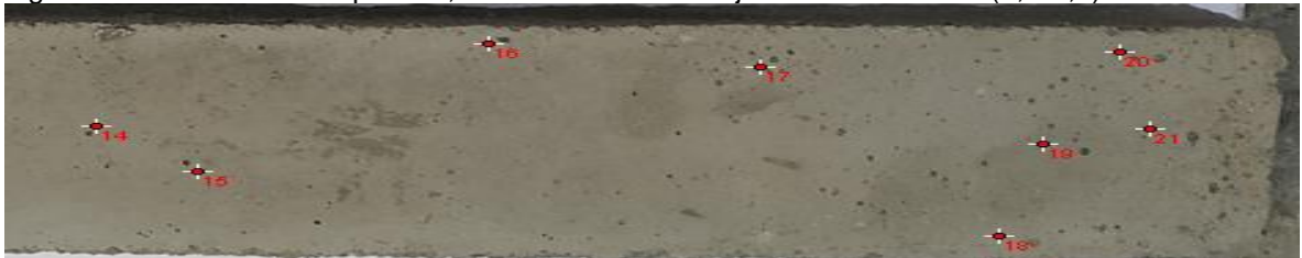
Figura 98. Sección 2 de la pieza 1, distribución de burbujas de diámetro D2 (1,1-2,0) mm
