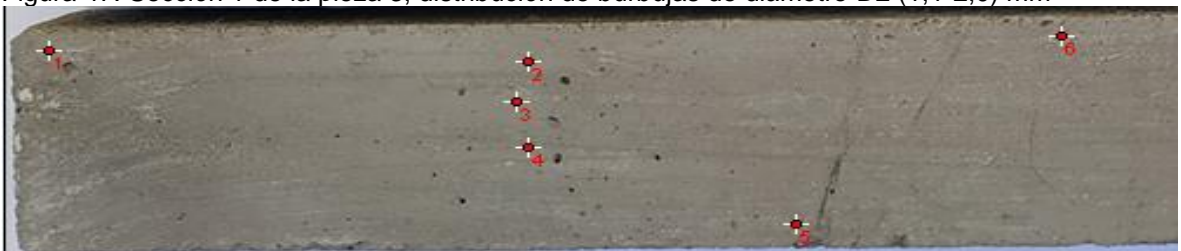
Figura 47. Sección 1 de la pieza 3, distribución de burbujas de diámetro D2 (1,1-2,0) mm
