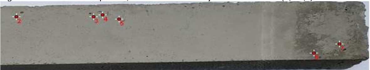
Figura 53. Sección 2 de la pieza 1, distribución de burbujas de diámetro D2 (1,1-2,0) mm
