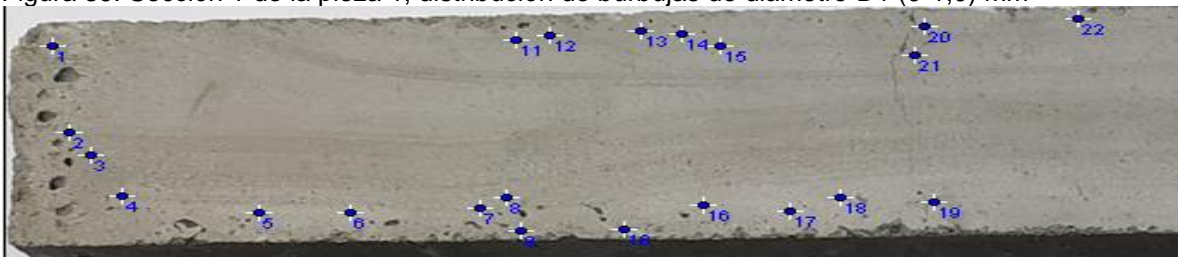
Figura 39. Sección 1 de la pieza 1, distribución de burbujas de diámetro D1 (0-1,0) mm
