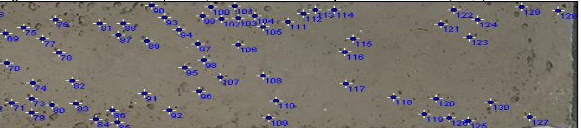
Figura 110. Sección 2 de la pieza 3, distribución de burbujas de diámetro D1 (0-1,0) mm
