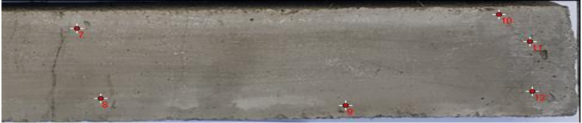
Figura 48. Sección 2 de la pieza 3, distribución de burbujas de diámetro D2 (1,1-2,0) mm
