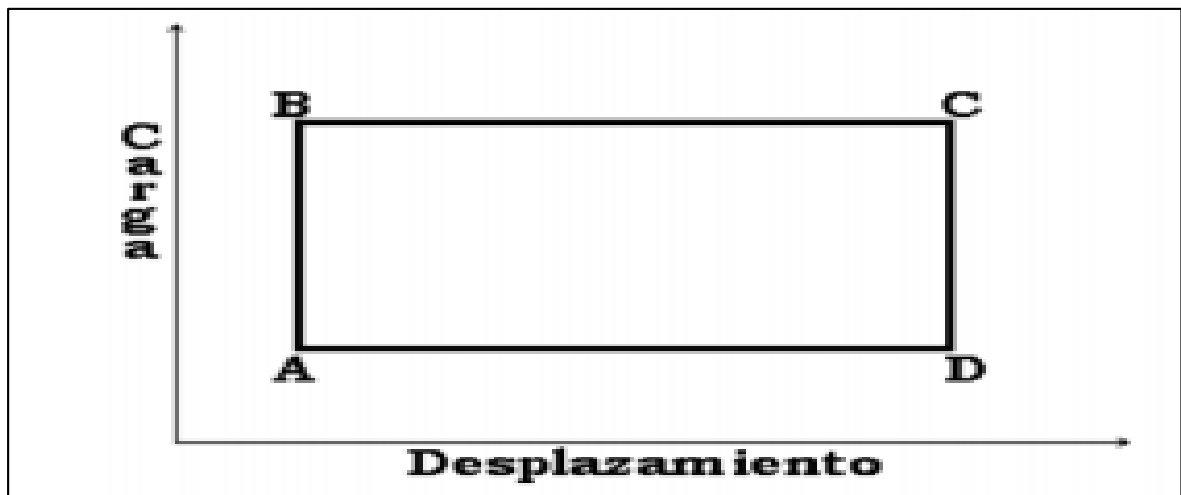
Imagen 4. Carta dinamométrica de superficie, caso ideal
