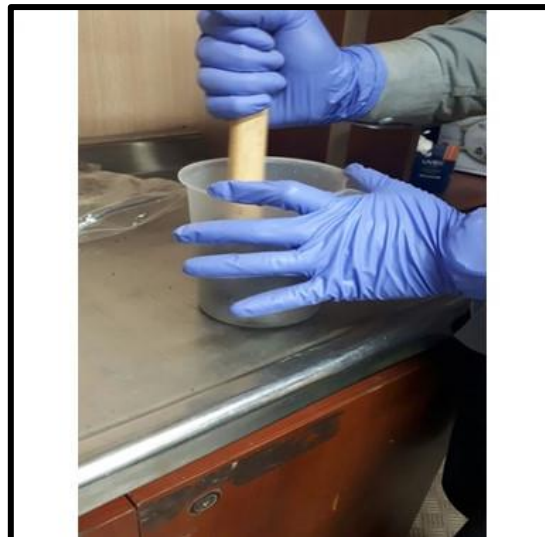
Figura 23. Compactación de los recortes.
