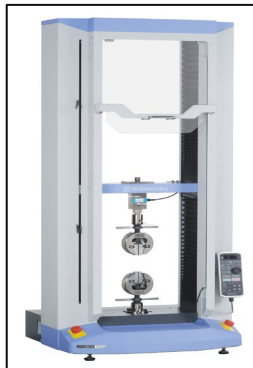
Figura 14. Imagen representativa para máquina universal de ensayos marca shimadzu
