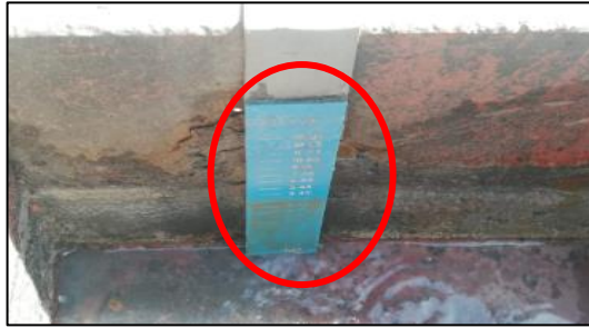
Figura 15. Regla para medir el caudal a la salida del vertimiento.
