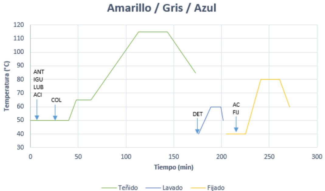
Gráfica 4. Proceso actual para los tonos amarillo (U146801), gris (U955003) y azul (U775011)
