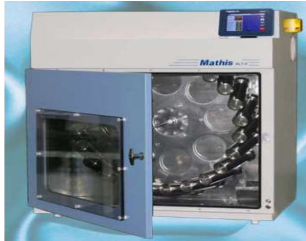
Imagen 7. Maquina Mathis para teñido textil en laboratorio
