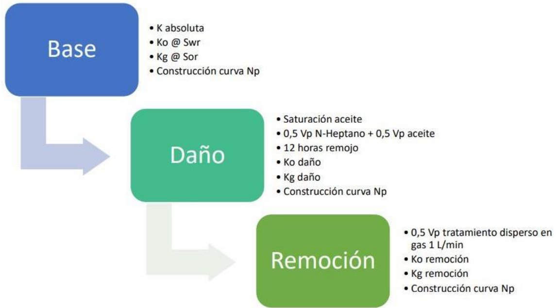
Figura 7: Protocolo Prueba desplazamiento de núcleos.
