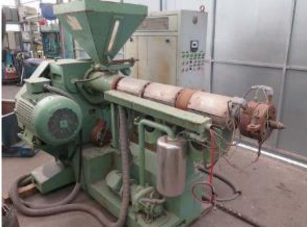
Imagen 20. Extrusora Monohusillo referencia Eurotecno E4535.
