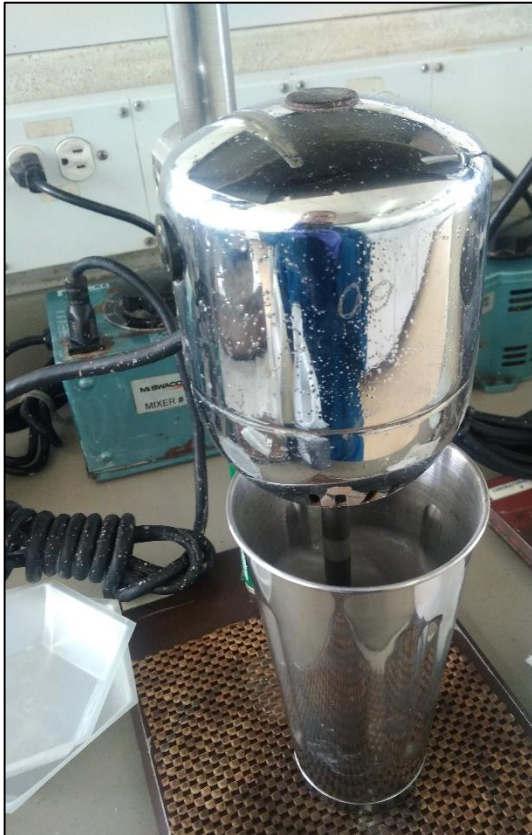
Ilustración 17. Agitador del fluido de perforación
