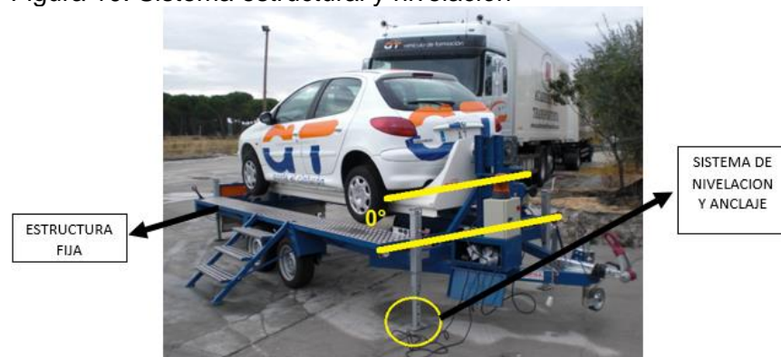
Figura 10. Sistema estructural y nivelación
