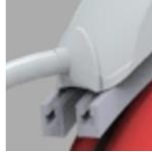
Imagen 51. Acople manguera con túnel de viento
