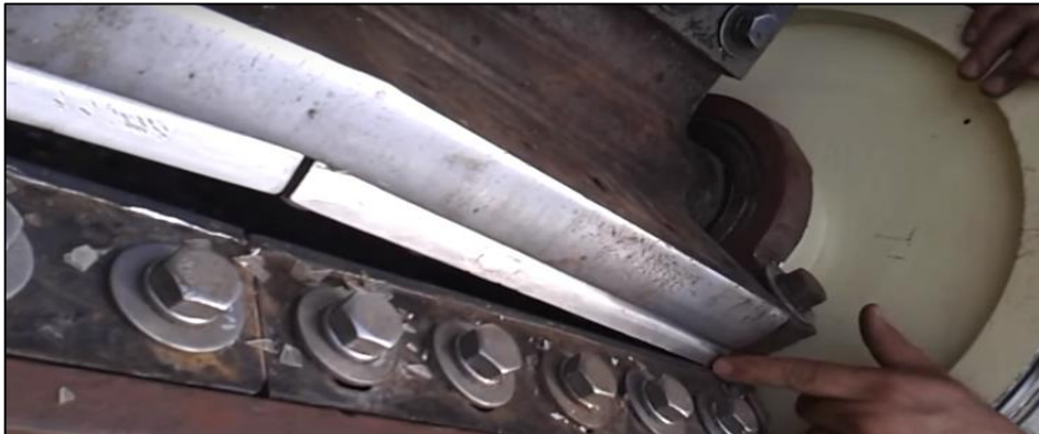
Imagen 4. Un eje con doble cuchilla tipo flecha
