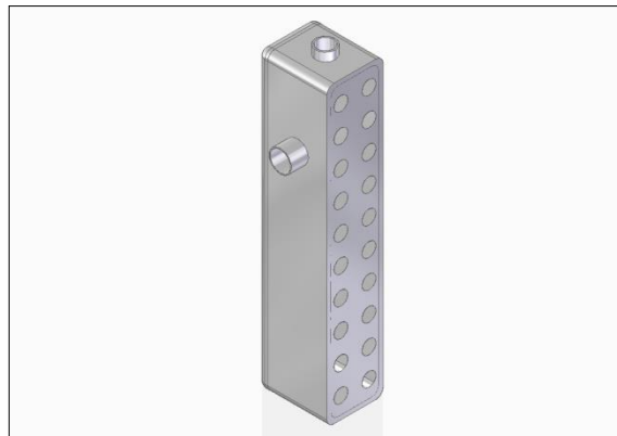
Imagen 52. Compartimiento lateral de Refrigerante del intercambiador
