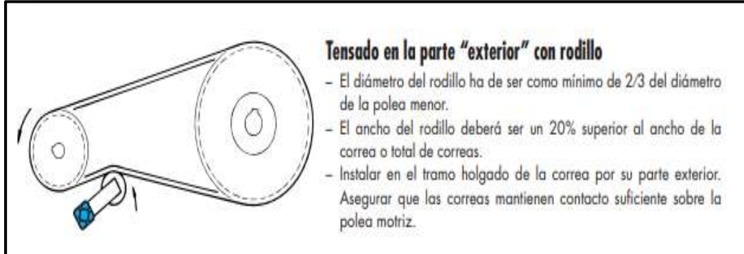
Imagen 41. Tensado por rodillo
