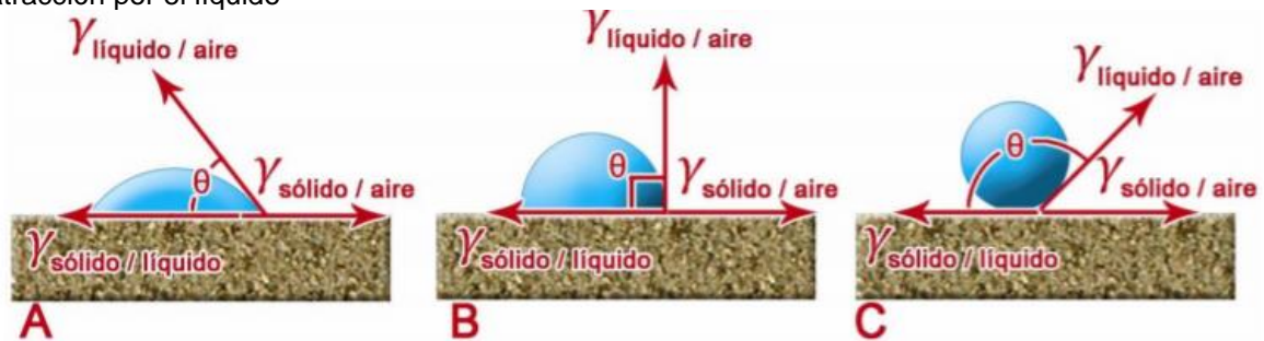
Figura 4. Gota de un líquido sobre tres diferentes superficies sólidas. De A a C disminuye la atracción por el líquido
