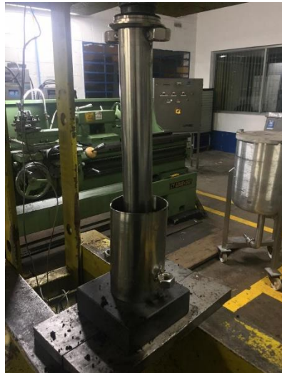
Figura 17. Prensa hidráulica usada en la elaboración de las briquetas.
