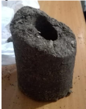
Figura 22. Briqueta elaborada con aserrín de madera como aglomerante.
