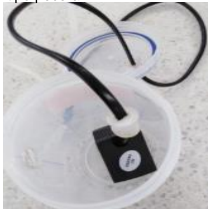
Figura 8. Sistema de agitación neumático - Bomba sumergible tipo pecera.
