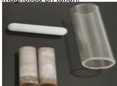
Figura 22. Piezas empleadas para Downcomer (Tubo en vidrio), conexiones (Tubos en acero en inoxidable) y barra magnética en teflón.
