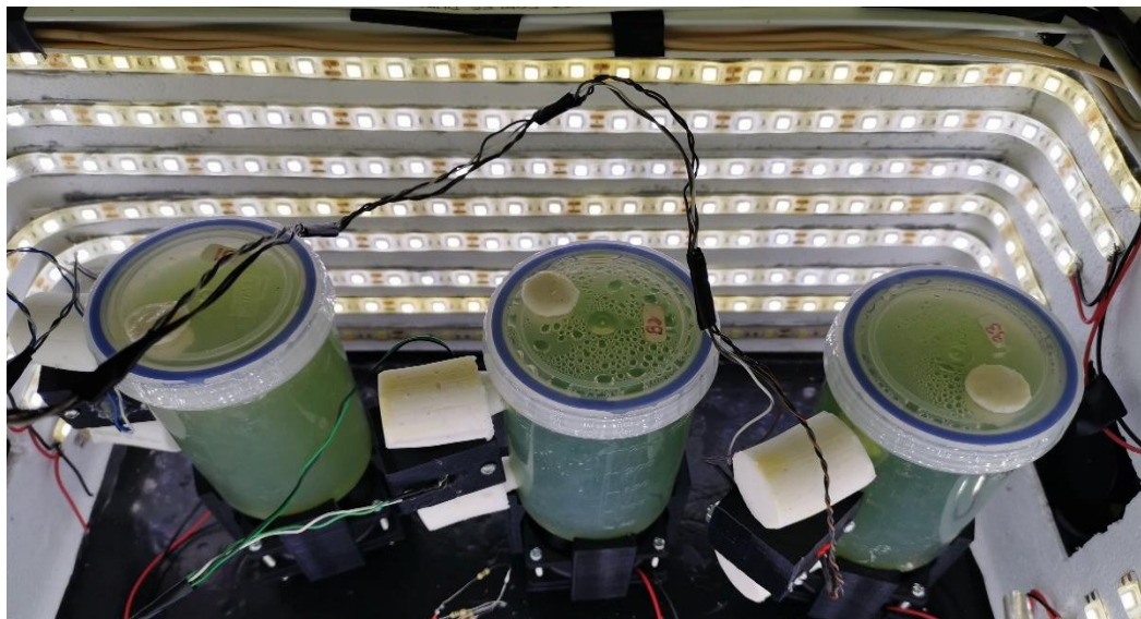
Figura 39. Cámara de incubación con sistema de agitación magnético y sensores de medida.
