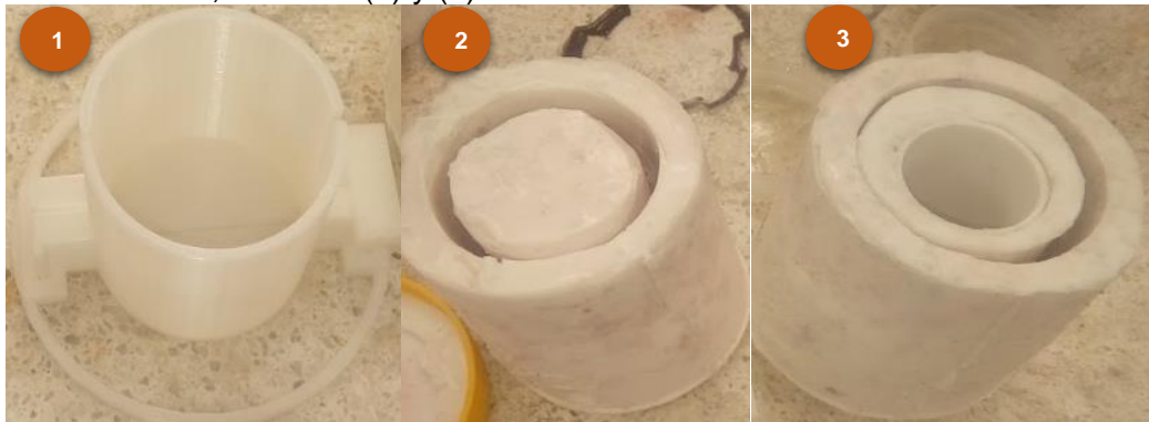
Figura 16. Moldes elaborados en caucho-silicona. Donde (1) se refiere a la pieza en PLA empleada para realizar los moldes en caucho-silicona del cuerpo del biorreactor, mientras (2) y (3) son el resultado final de los moldes.
