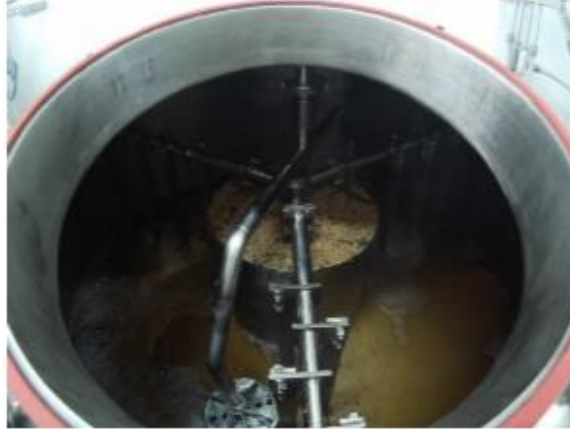
Figura 11. Cama de grano al final del lavado.
