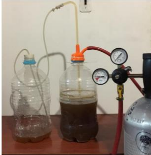
Figura 36. Trasvase de cerveza a fermentador secundario.
