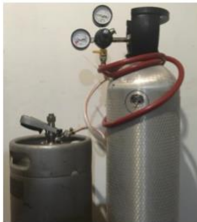
Figura 37. Carbonatación forzada de cerveza.
