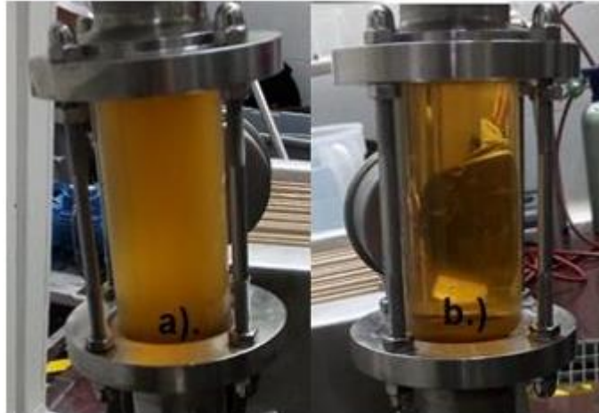
Figura 17. Entrada y salida del filtro. (a) Cerveza sin filtrar. (b) Cerveza filtrada.
