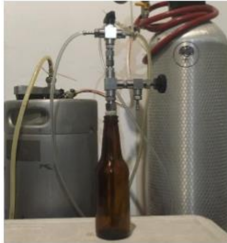
Figura 38. Llenado de botellas a contrapresión
