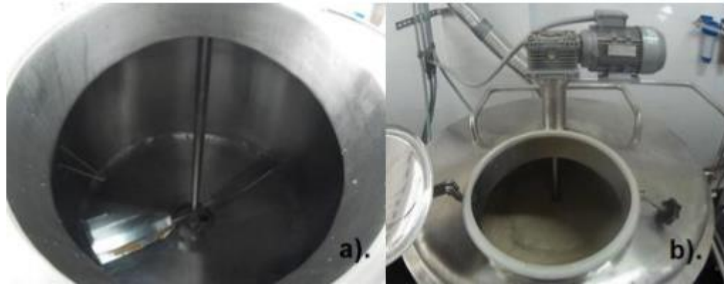
Figura 9. Equipo de macerado (a) Interior del equipo (b) Mezcla de agua de macerado y malta molida.
