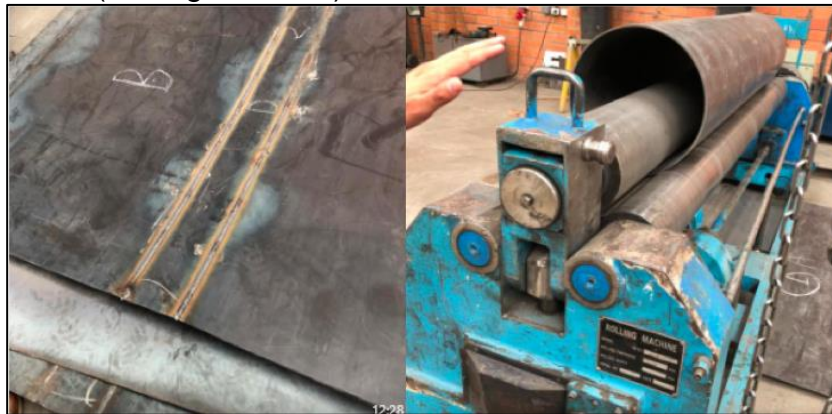
Imagen 5. Láminas soldadas y proceso de obtención de forma (Rolling machine).
