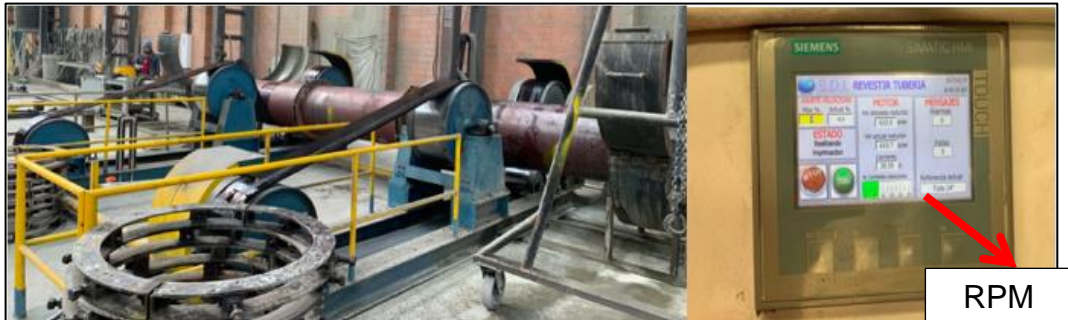
Imagen 9. Máquina de revestimiento interno.
