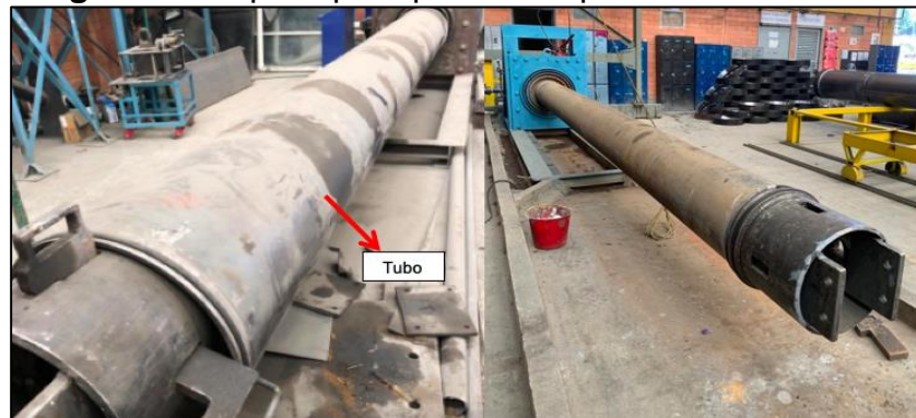
Imagen 8. Máquina para prueba de presión hidrostática.
