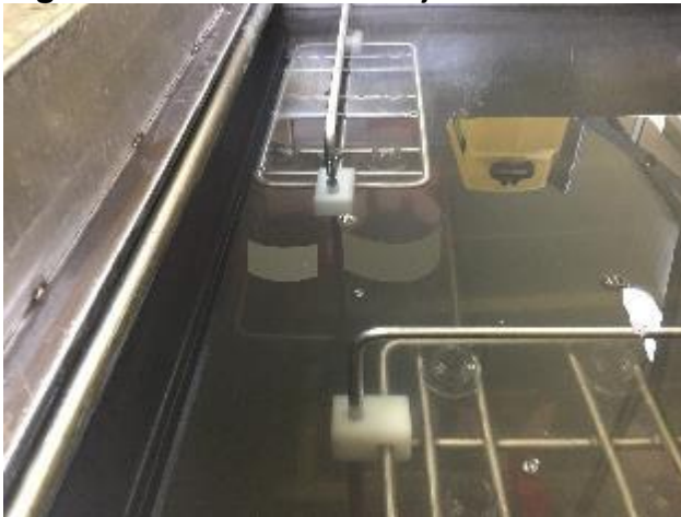
Figura 13. Inmersión de rejillas en la lavadora con solución cáustica
