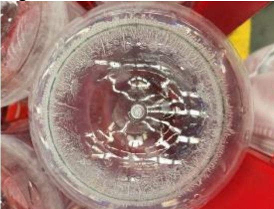
Figura 7. Base de botella con stress cracking
