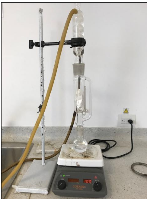
Imagen 15. Montaje de extracción Soxhlet utilizado.
