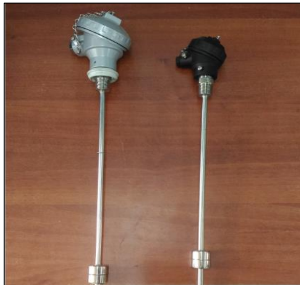
Imagen 19. Sensores de nivel encontrados en el laboratorio
