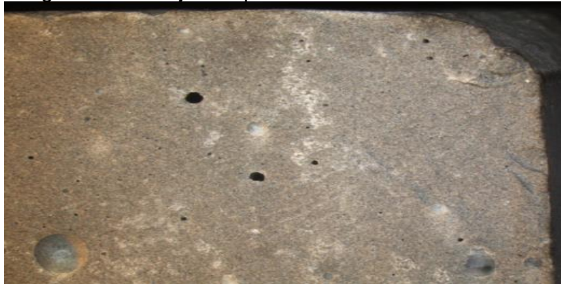
Imagen 40. Burbujas en probetas a tensión en cerámico
