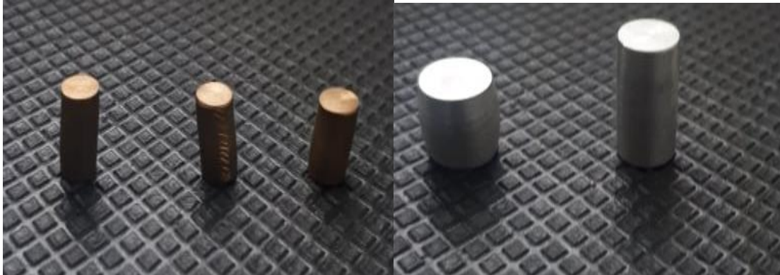
Imagen 41. Probetas finales aluminio y bronce
