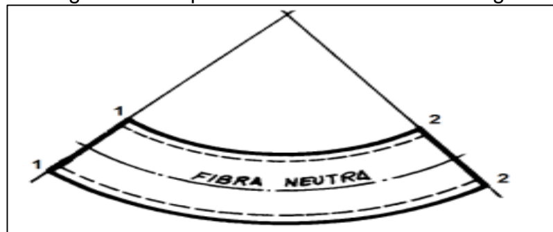
Figura 6. Comportamiento a flexión de una viga
