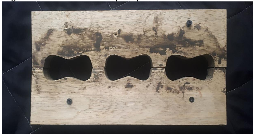
Imagen 26. Molde de madera para probetas de tensión.
