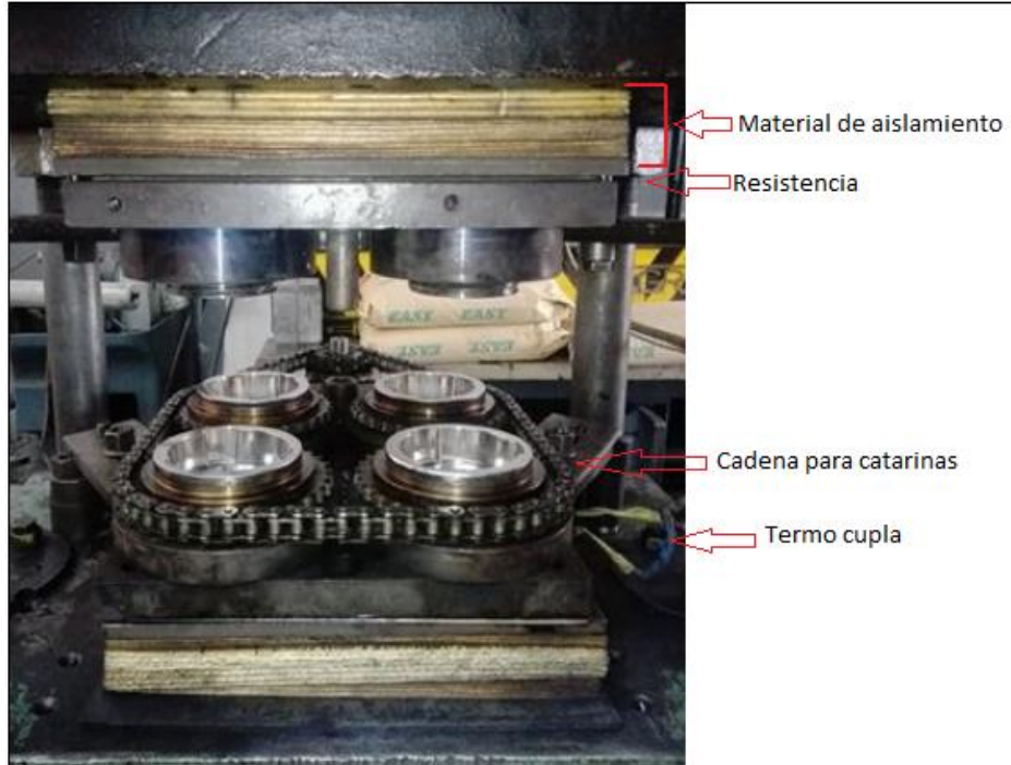
Imagen 4. Sistema de calefacción
