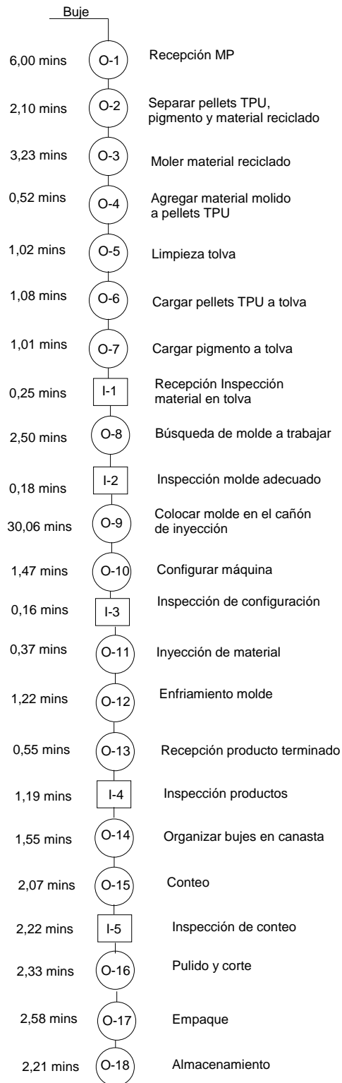
Diagrama 3. Diagrama actual de operaciones de buje muelle para Toyota Land Cruiser
