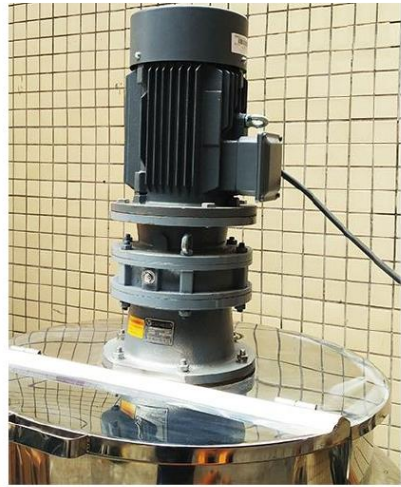
Upper Mixer Motor (SIEMENS)
