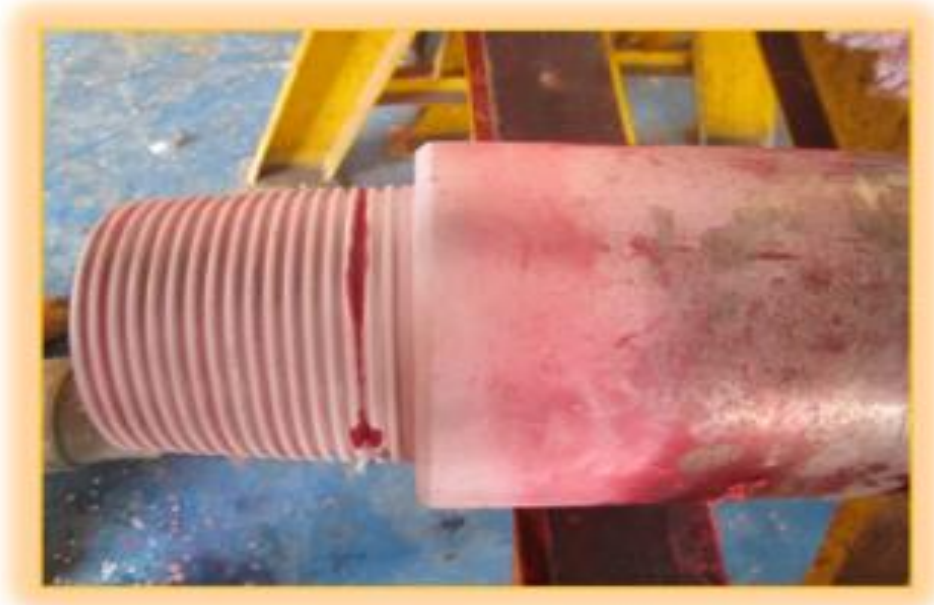
Imagen 6. Inspección con Líquidos Penetrantes
