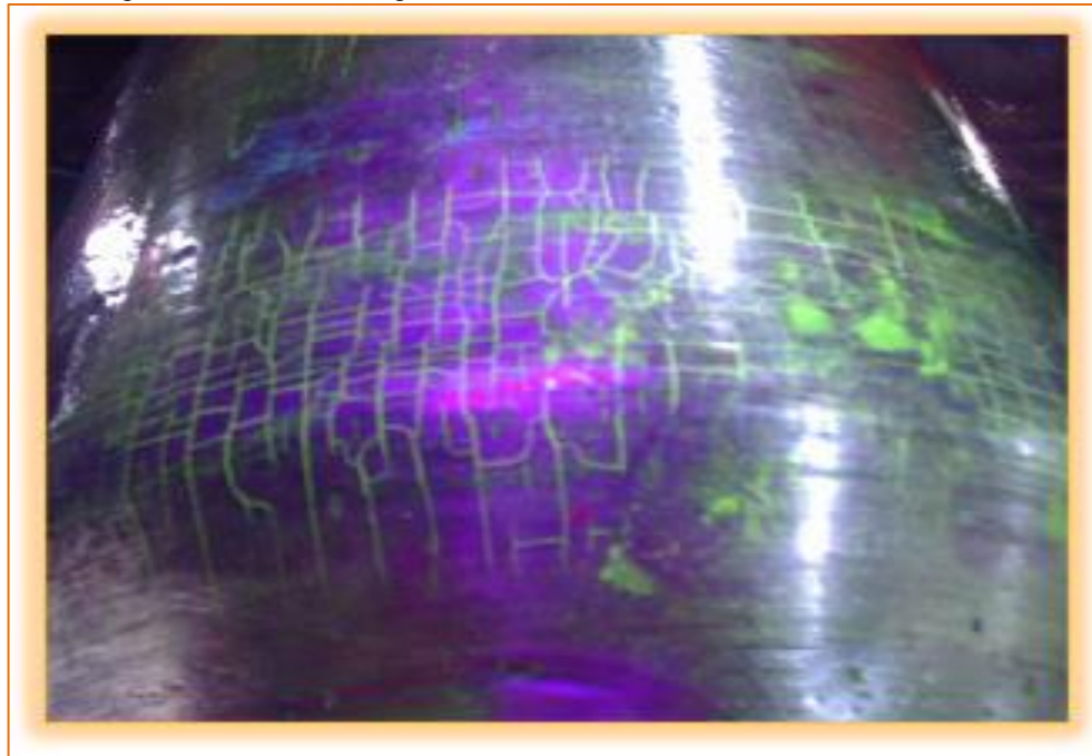
Imagen 4. Partículas Magnéticas Húmedas Fluorescentes
