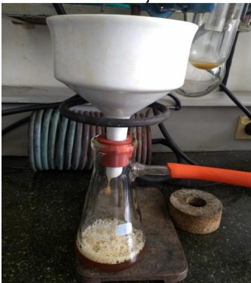
Ilustración 9. Montaje filtración Buchner.
