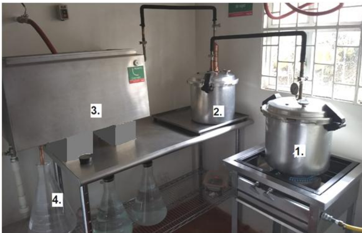
Ilustración 20. Sistema producción agua de rosas/Hidrolato.
