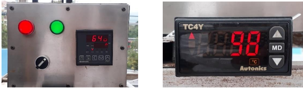
(a) Controlador de temperatura de las resistencias, TC4Y. (b) Medidor de temperatura de la salida del reactor, X7.
