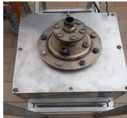
Imagen 8. Montaje del reactor en cobertura cerámica
