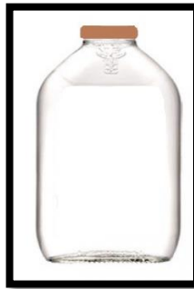
Figura 7. Fotobiorreactor adaptado de 375 mL
