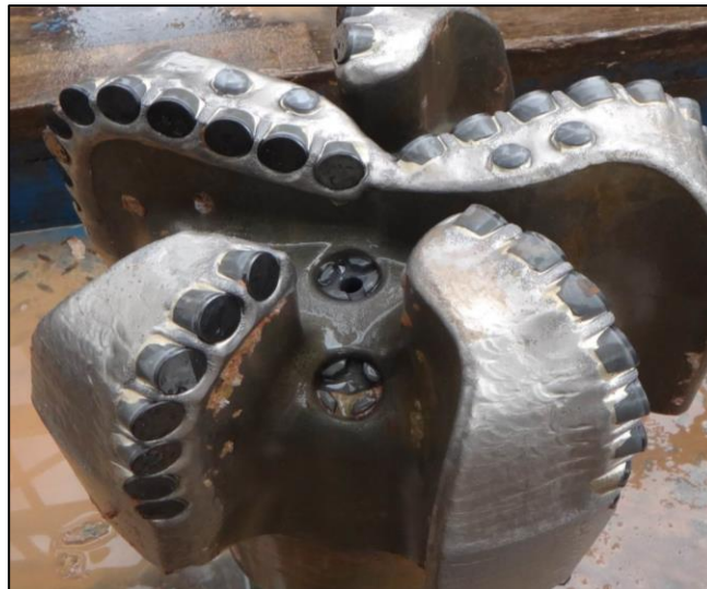
Figura 19. Vista de la broca PDC posterior a la corrida en el pozo A.
