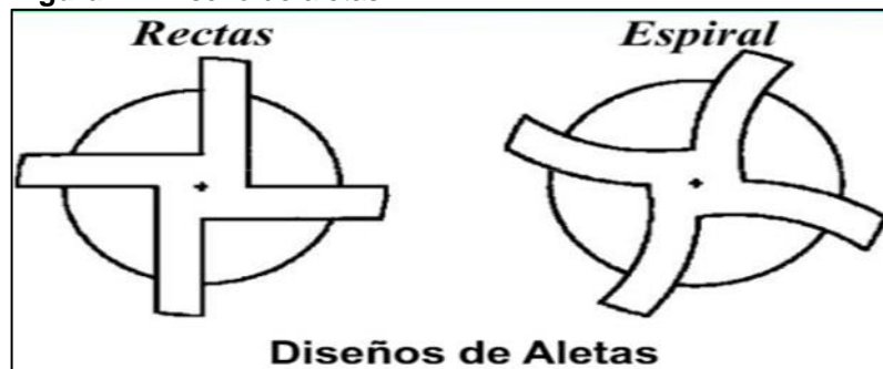
Figura 12. Diseño de aletas
