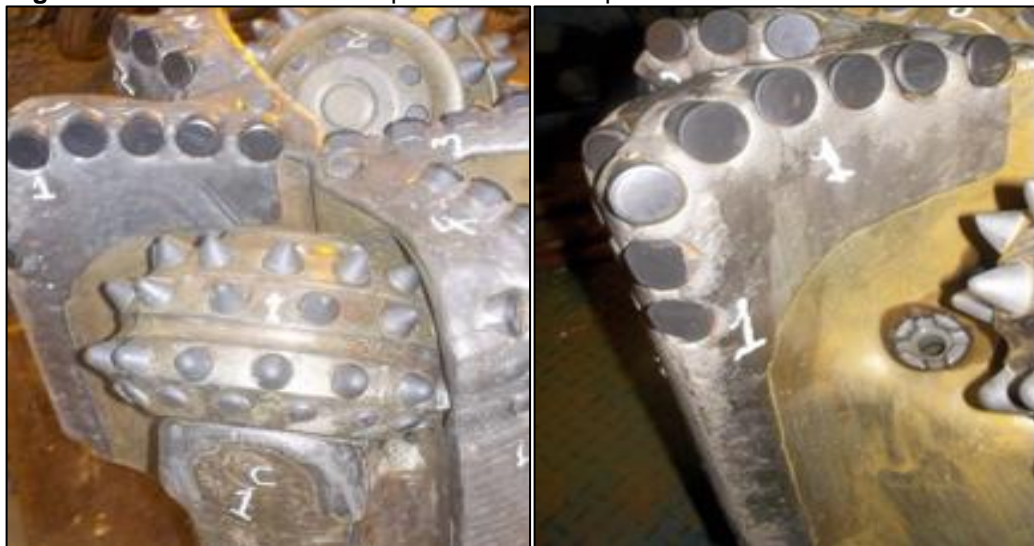
Figura 22. Broca KYMERA 624 post-corrída en el pozo D.
