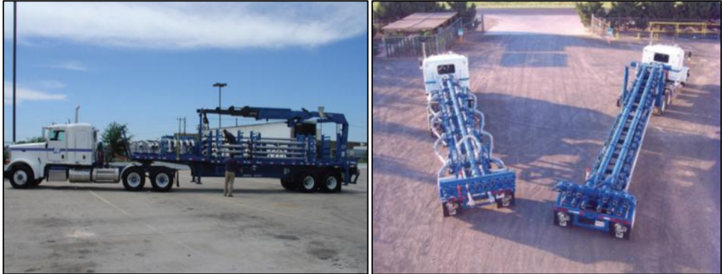
Figura 26. Líneas de alta presión y Manifold's
