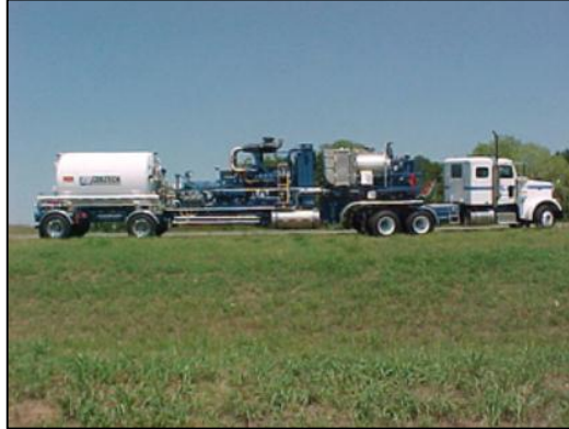
Figura 25. Equipo de Bombeo de N2
