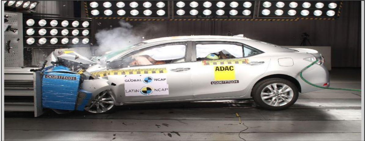
Figura 4. Impacto frontal superposición completa
