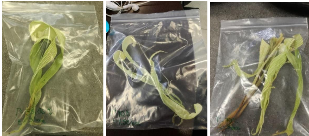
Figura 20. Muestras después del secado. a) 55,86°C; 3h. b) 70°; 1,58h. c) 70°C; 3h d) 70°C; 4,41h. e) 60°C; 2h. f) 80°C; 2h. g) 80°C; 4h. h) 84,14°C; 3h
