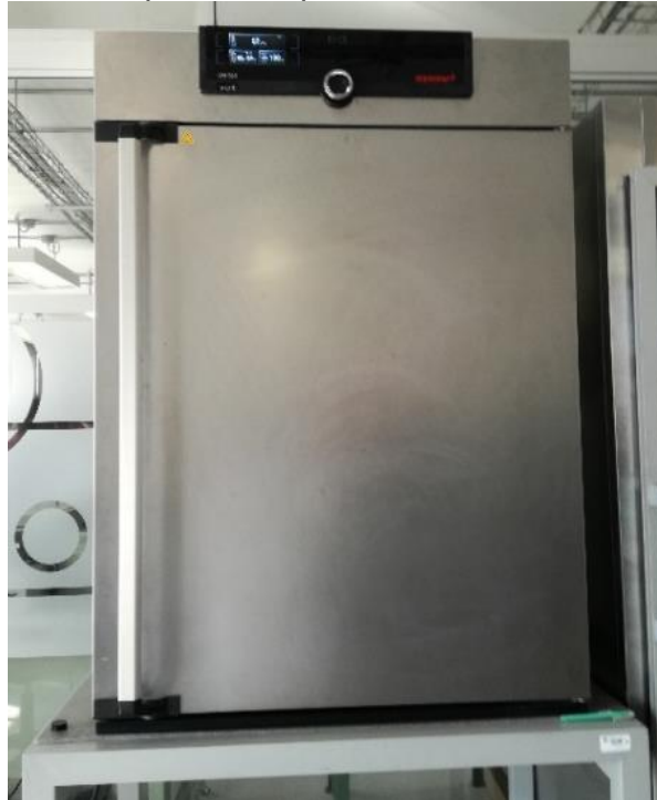
Figura 5. Horno Mermert UN 240 utilizado para las operaciones de secado
