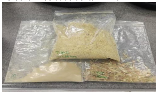
Figura 29. Tamizado del segundo lote de hojas secas. Izquierda: Residuo de los fondos; Centro: Residuos del tamiz 80; Derecha: Residuos del tamiz 10
