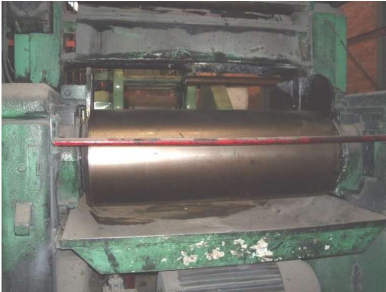
Imagen 2. Molino de rodillos o italiano marca Rubber
