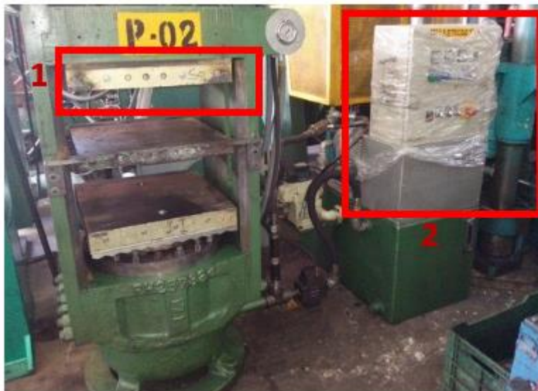
Imagen 15. Prensa Guix 200 toneladas con tablero electrónico de control
