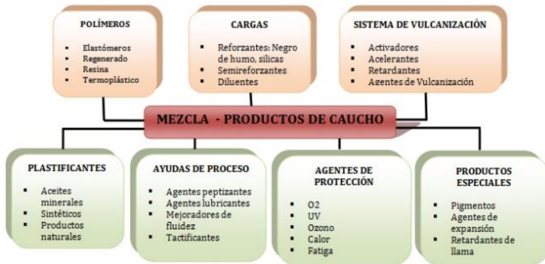
Figura 2. Componentes utilizados para realizar una formulación del caucho
