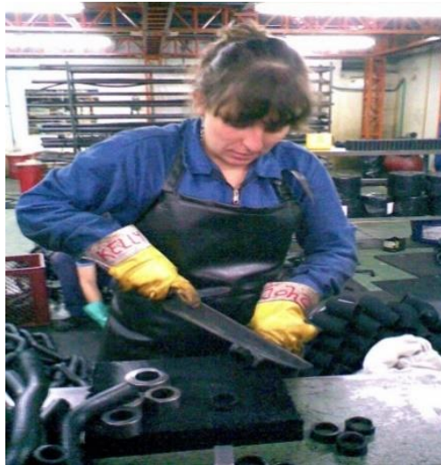
Imagen 12. Proceso de Refilado
