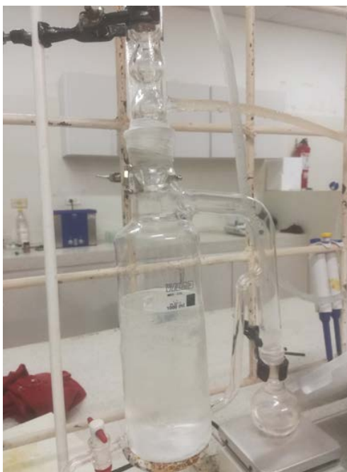
Imagen 12. Montaje extracción líquido-líquido
