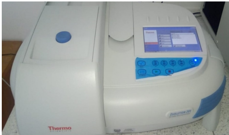
Imagen 10. Espectrofotómetro Evolution 201 Thermo Scientific.
