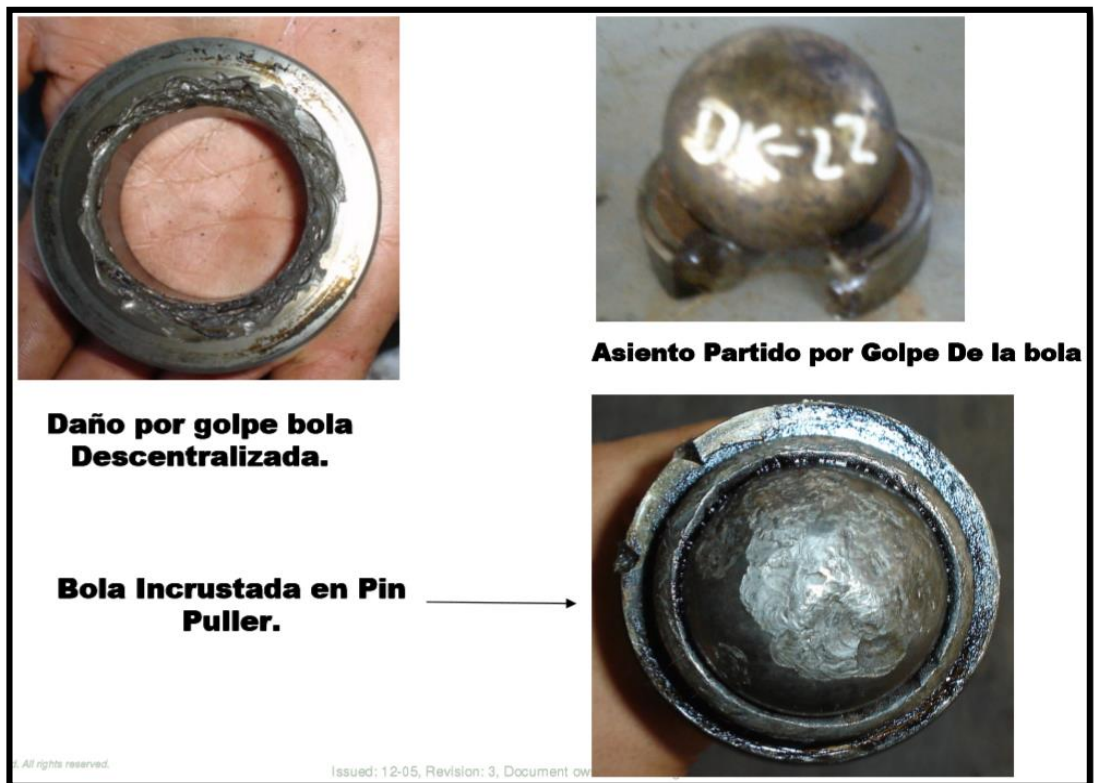
Figura 27. Daños comunes válvulas bola y asiento.
