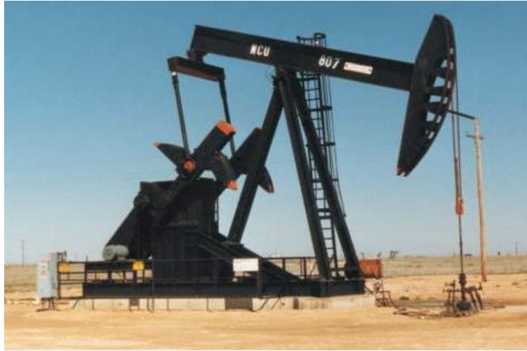
Figura 11. Unidad de bombeo convencional clase I
