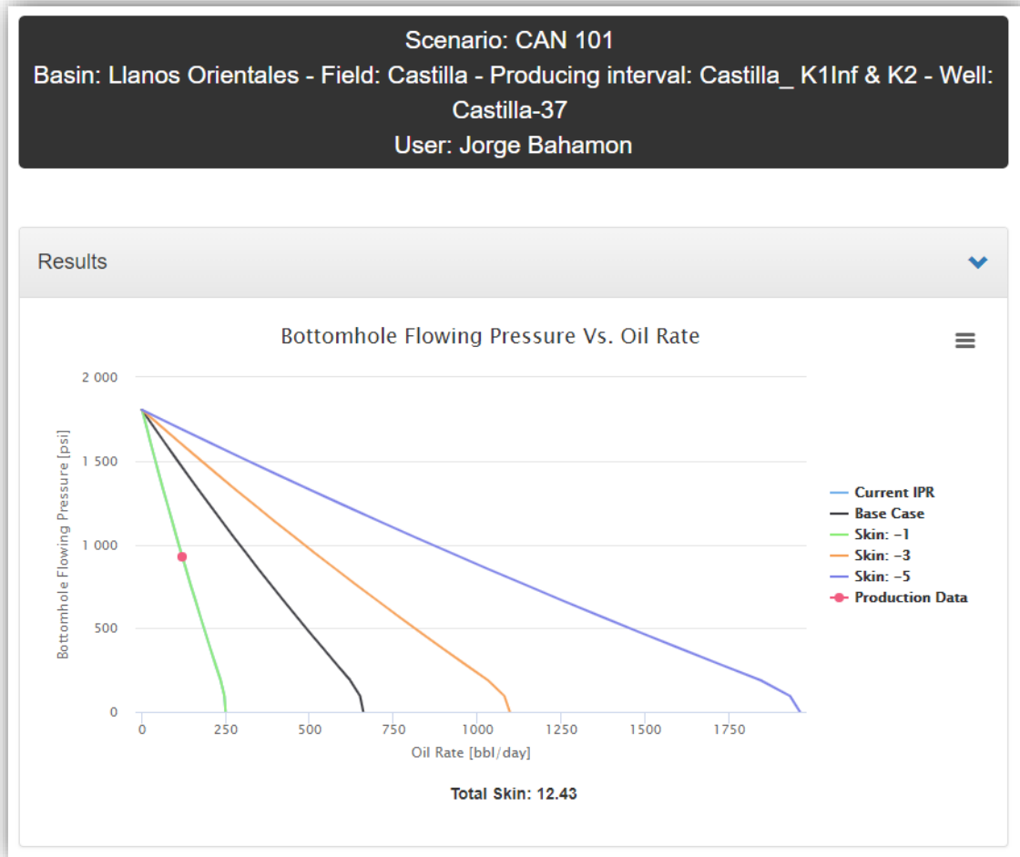
Gráfica 6. Análisis nodal previo al fracturamiento hidráulico pozo CA 101
