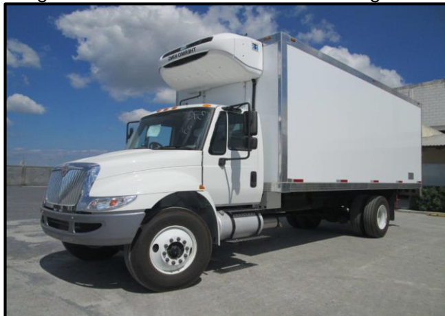
Imagen 30. Vehículo con sistema de refrigeración.
