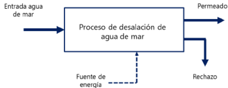
Imagen 1. Esquema general de un proceso de desalación de agua de mar
