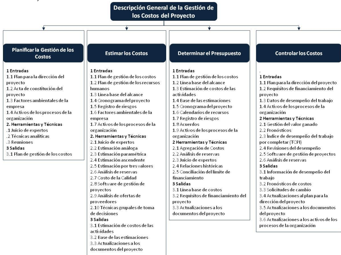
Gráfico 39 Descripción General de la Gestión de los Costos del Proyecto (Basado en el PMBOK®)
