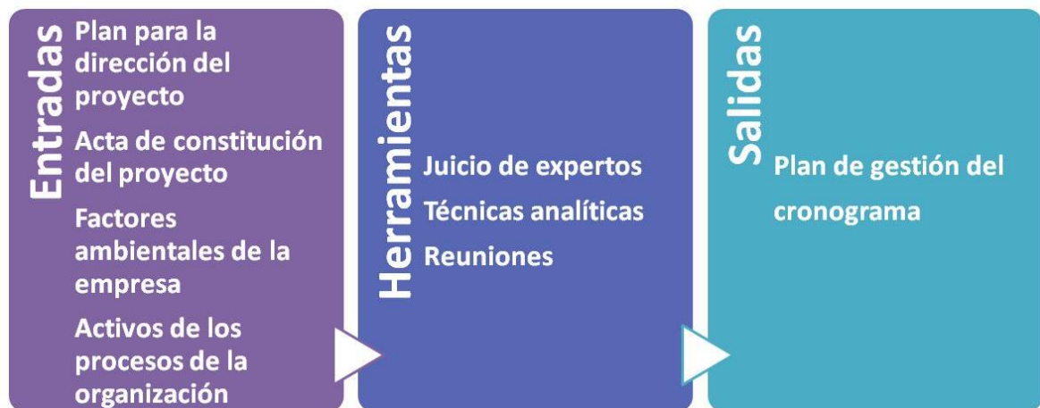
Gráfico 53 Planificar el Cronograma: Entradas, Herramientas y Técnicas, y Salidas (Basado en la Guía del PMBOK®)
