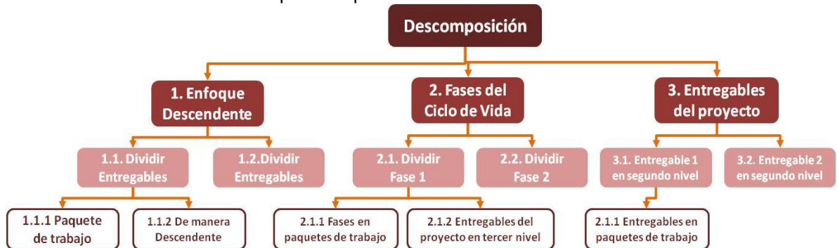
Gráfico 51 Métodos de Descomposición para crear la EDT/WBS
