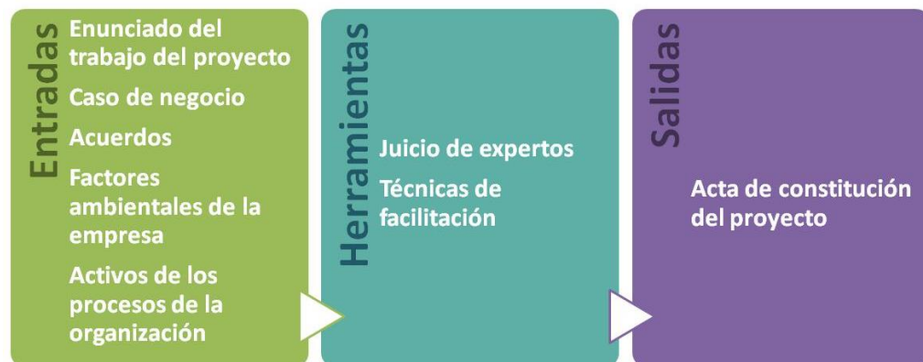
Gráfico 43 Desarrollar el Acta de Constitución del Proyecto: Entradas, Herramientas y Técnicas, y Salidas (Basado en la Guía del PMBOK®)
